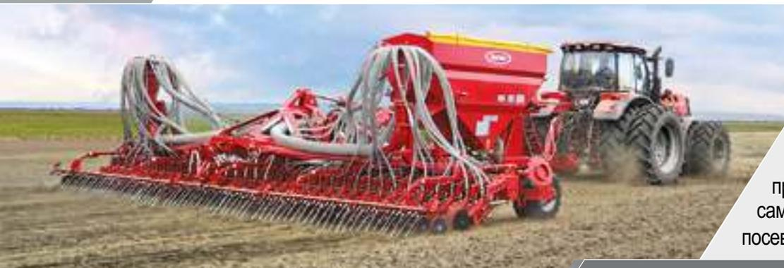
Предназначен для предпосевной обработки почвы и рядового сева зерновых, среднесеменных зернобобовых и других, аналогичных им по размерам, норме высева и глубине заделки семян, культур с одновременным внесением гранулированных минеральных удобрений.
