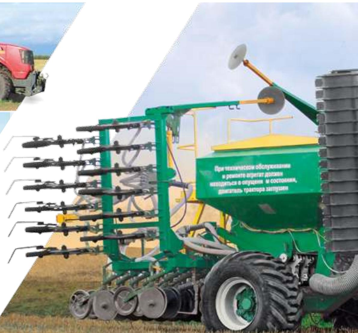
Предназначен для предпосевной обработки почвы и посева зерновых колосовых культур, среднесеменных зернобобовых и других, аналогичных им по размерам, норме высева и глубине заделки семян, культур с одновременным внесением в посевные бороздки стартовой дозы гранулированных фосфорных удобрений.
