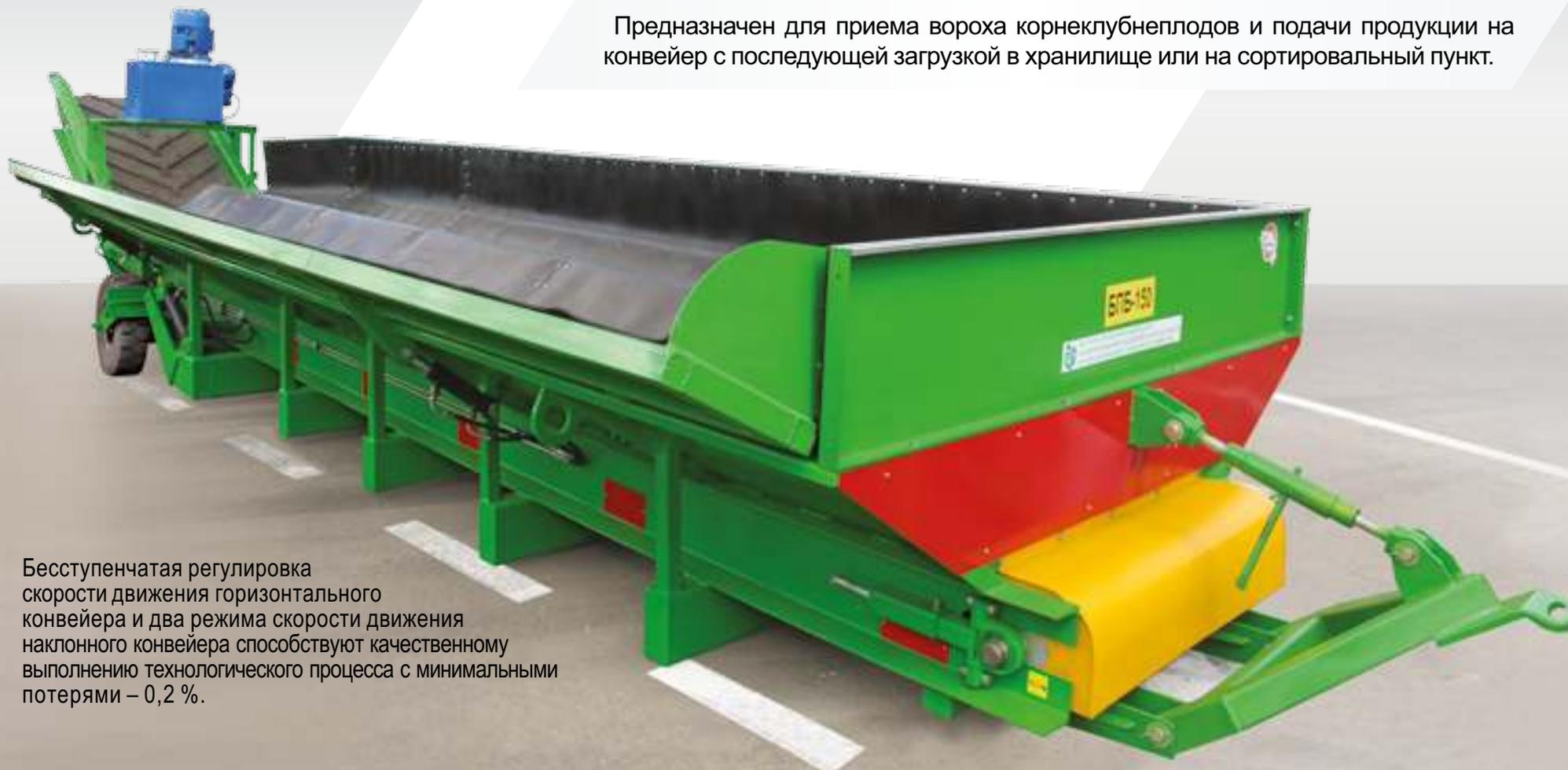
Бесступенчатая регулировка скорости движения горизонтального конвейера и два режима скорости движения наклонного конвейера способствуют качественному выполнению технологического процесса с минимальными потерями – 0,2 %.
