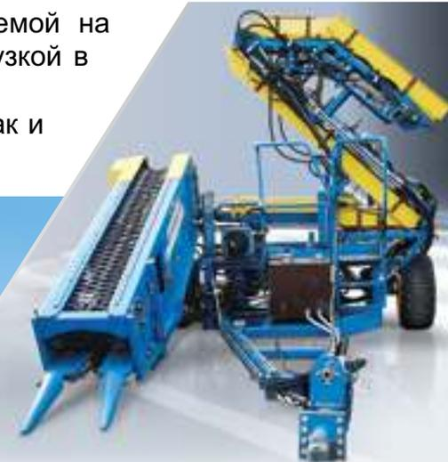
Комбайны оборудованы очищающей системой для эффективного отделения листьев, за которой расположен сортировочный стол для инспекции капусты перед загрузкой в контейнер или кузов транспортного средства. Привод рабочих органов комбайна – от автономной гидросистемы через ВОМ трактора.
