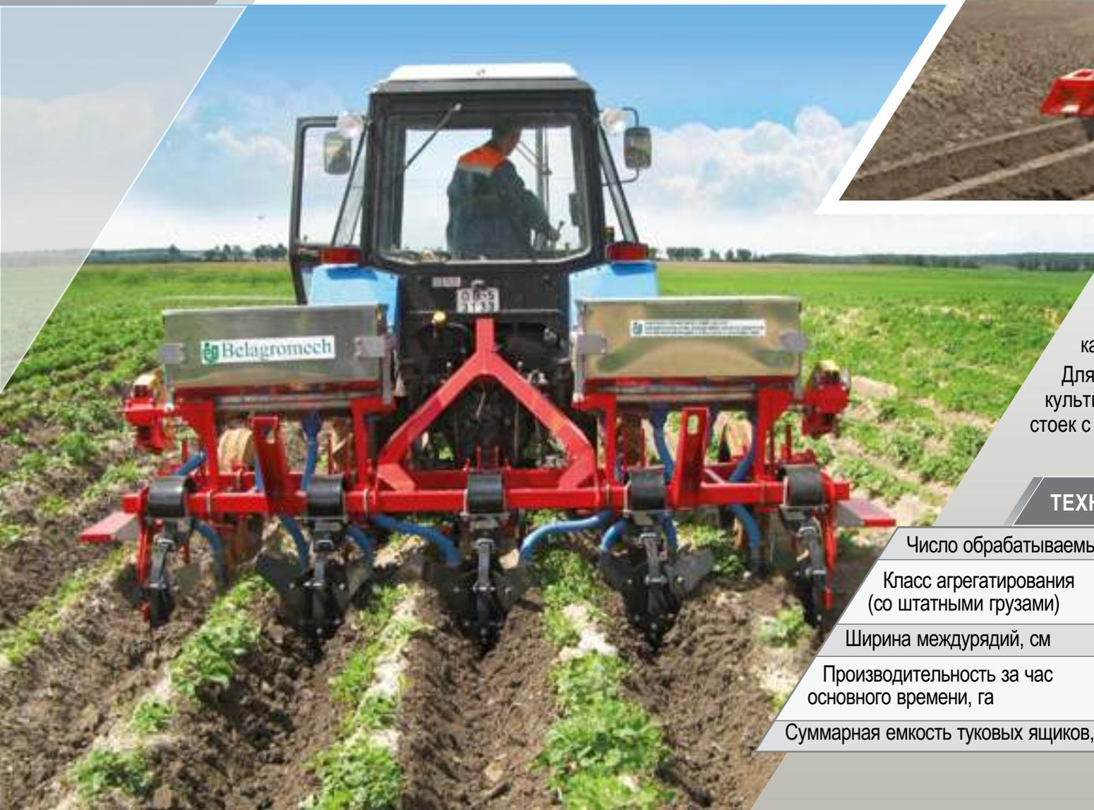
Рабочие органы культиватора установлены на мощных пружинных стойках, что позволяет использовать культиватор на почвах, засоренных камнями.
