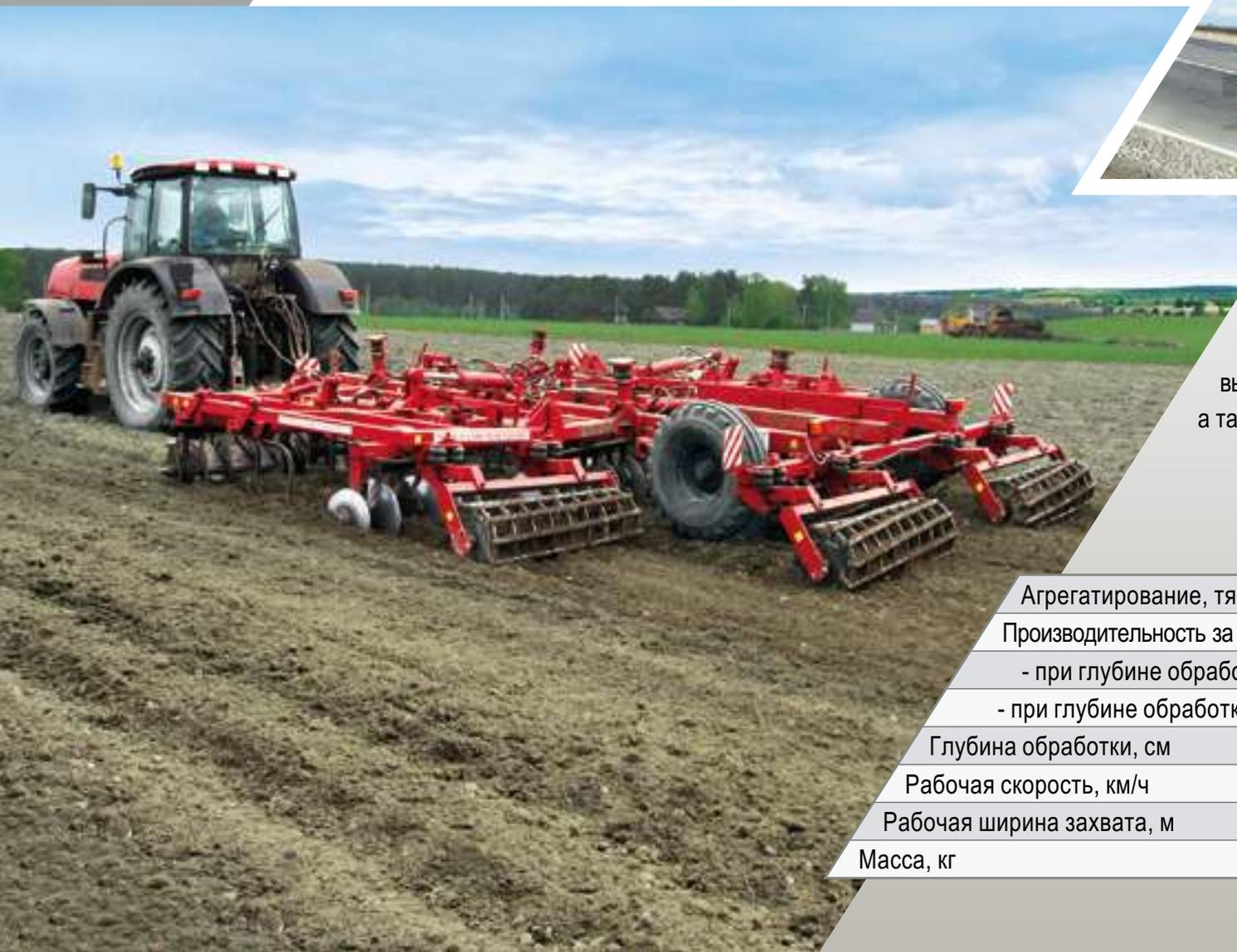
Наличие дисковых и лаповых рабочих органов позволяет производить обработку фонов, покрытых густой растительностью, например пласта многолетних трав, высокостебельных культур или полеглых хлебов, а также заделку высокостебельных сидератов.
