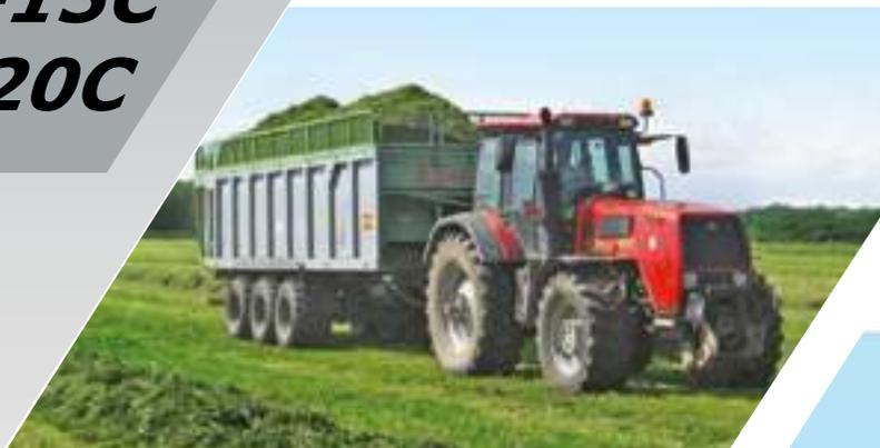
Полуприцепы самосвальные тракторные ПТ-15С и ПТ-20С предназначены для перевозки и выгрузки силосной и сенажной массы, зерна, комбикорма, корнеклубнеплодов, жома, строительных материалов, угля и других сыпучих грузов.
