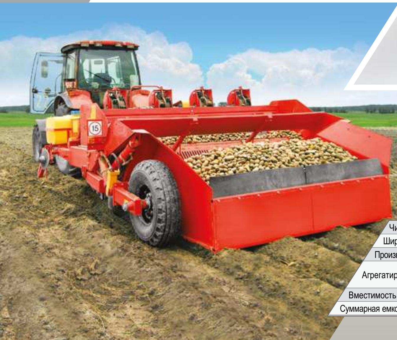
Две пары опорных колес обеспечивают поперечную устойчивость сажалки при работе на склонах.
