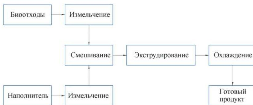
Рисунок 2. – Схема экструзии
