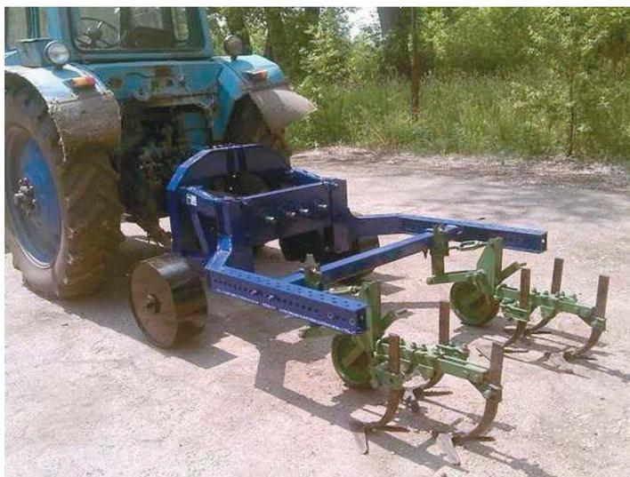
Рисунок 6. – Технологический модуль для междурядной обработки маточника УКМ–МО
