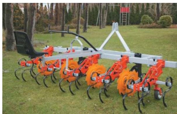
Рисунок 7. – Многофункциональный прополочный культиватор P501/1
