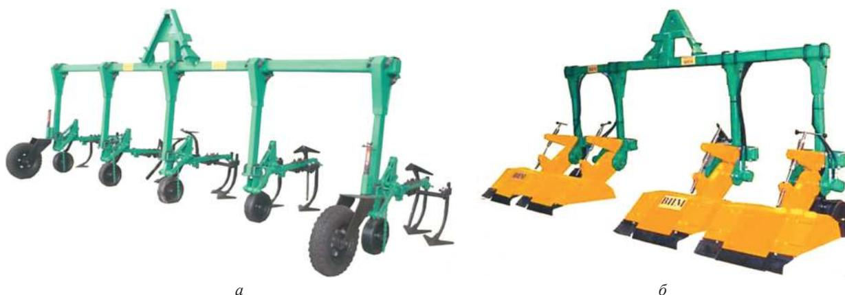
*а* – культиватор пропашной высококлиренсный; *б* – культиватор фрезерный высококлиренсный
