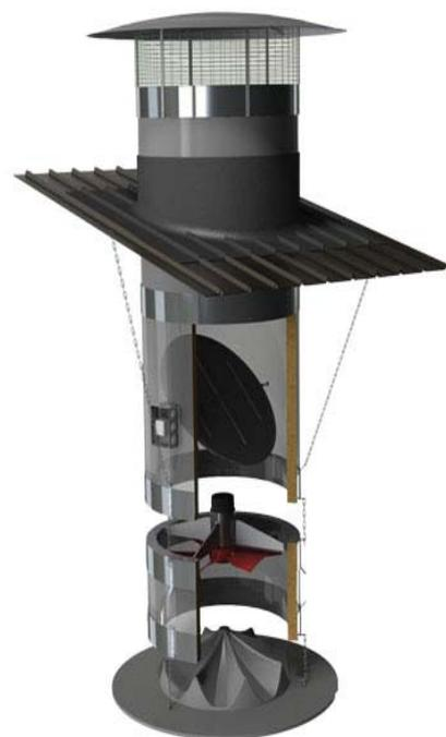
Рисунок 4. – Схема приточной шахты
