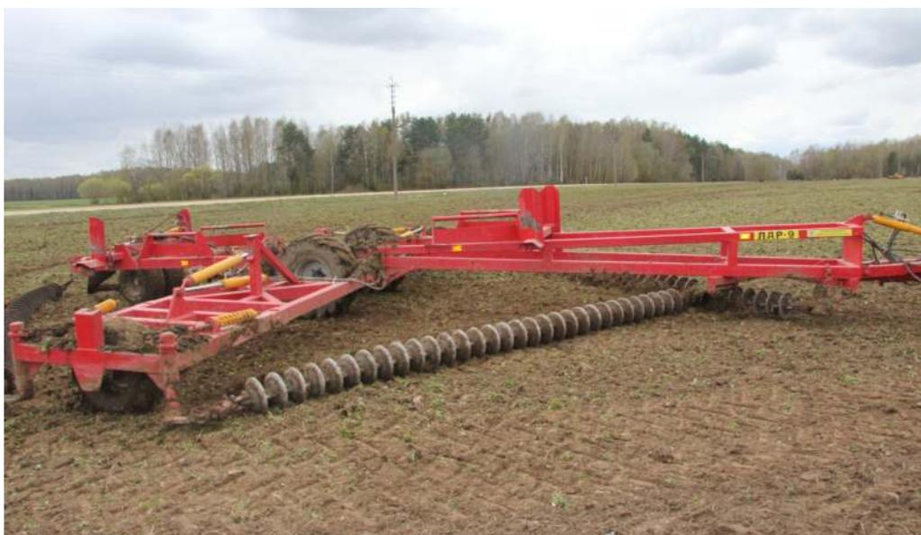
Рисунок 3. – Луцильник ЛДР-9 в рабочем положении
