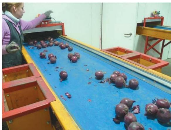
Рисунок 3. – Ленточные инспекционные столы
