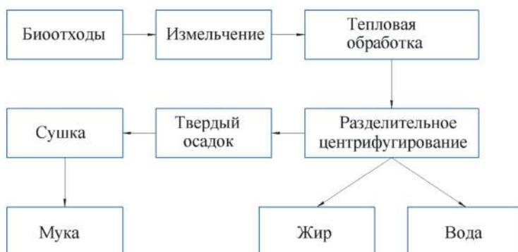
Рисунок 3. – Схема переработки боенских отходов (для получения муки)
