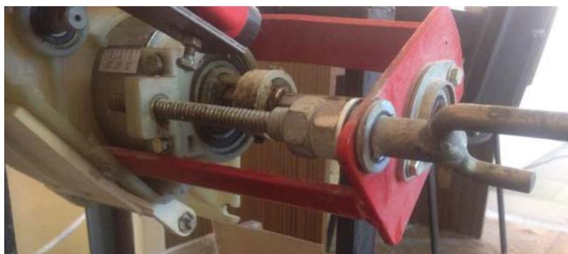
Рисунок 2. – Механизм регулировки нормы высева
