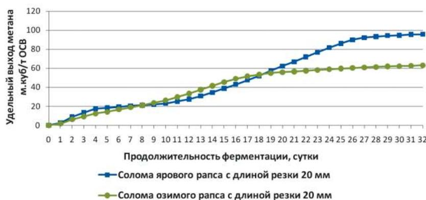
Рисунок 1. – Удельный выход метана с нарастающим итогом при анаэробной ферментации соломы ярового и озимого рапса
