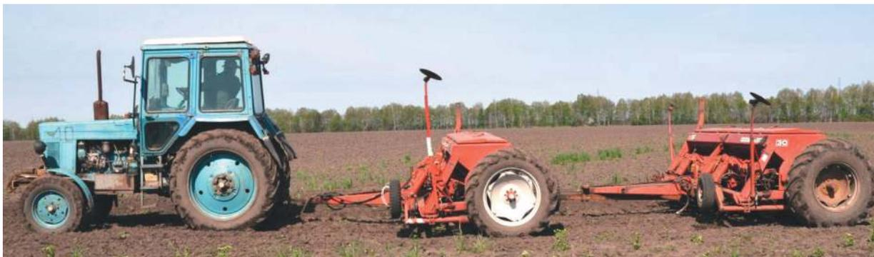
Рисунок 1. – Двосеялковый агрегат для ленточного внесения основных доз твердых минеральных удобрений, посева сельскохозяйственных культур и припосевного внесения удобрений стартовыми дозами
