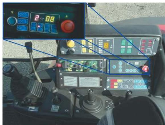
Рисунок 4. – Регулятора потока масла в тракторе «Беларус-3522»
