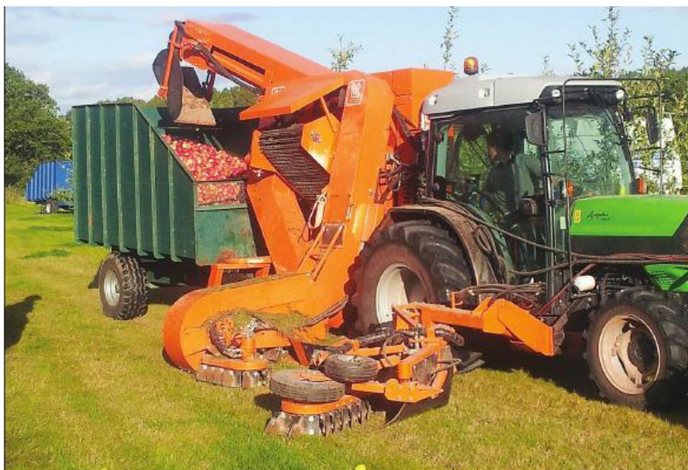
Рисунок 2. – Прицепной комбайн для уборки плодов с земли Tuthill Centipede 2015 Harvester производительностью 15 т/ч
