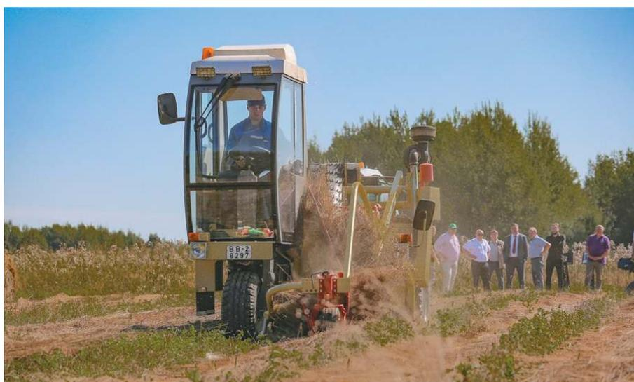
Рисунок 3. – Оборачиватель лент льна ОЛЛ-1
