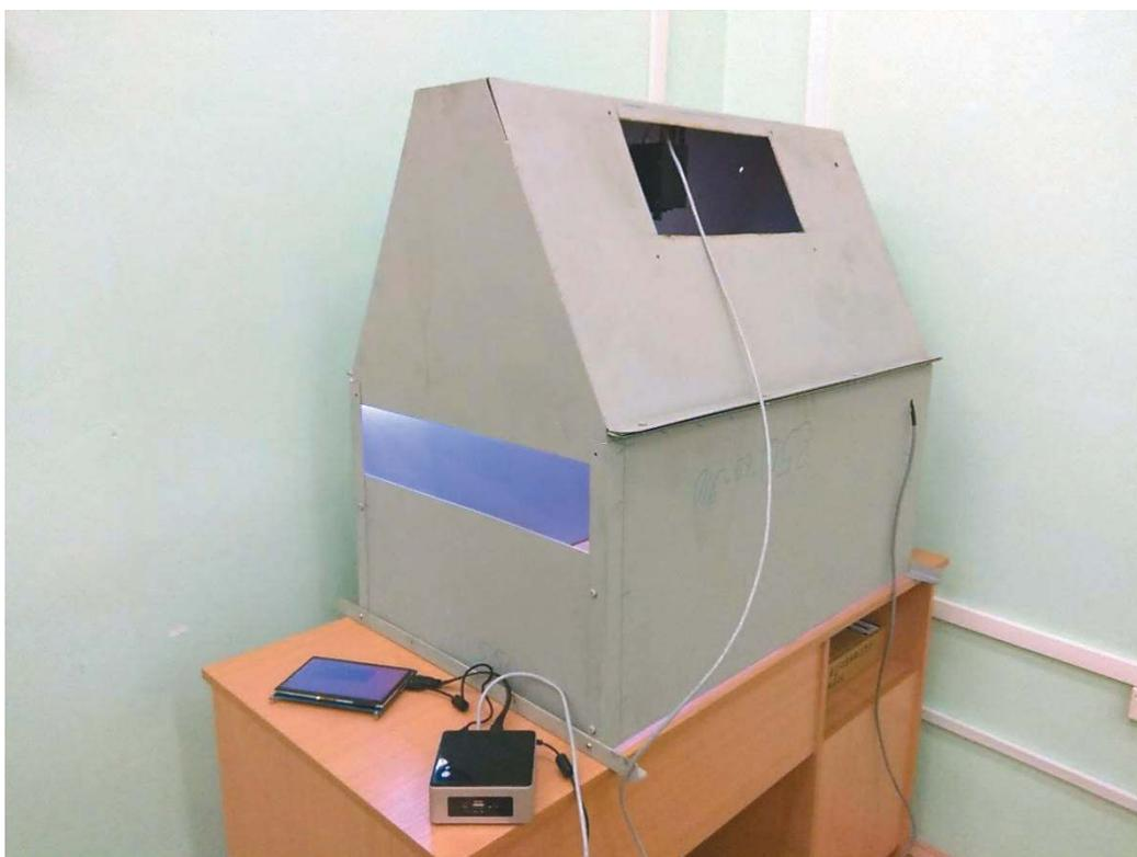
Рисунок 5. – Внешний вид разработанного прототипа системы технического зрения
