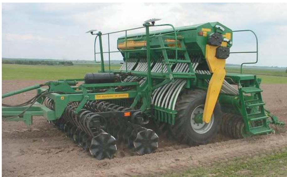
Рисунок 1. – Почвообрабатывающе-посевной агрегат для льна АПЛ-4
