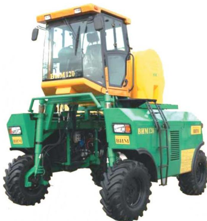
Рисунок 4. – Самоходное универсальное высококлиренсное гидрофицированное энергосредство с электронным управлением (СУВЭС)
