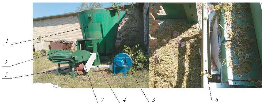
1 – питатель; 2 – сепаратор; 3 – вентилятор; 4 – трубопровод; 5 – диффузор;
