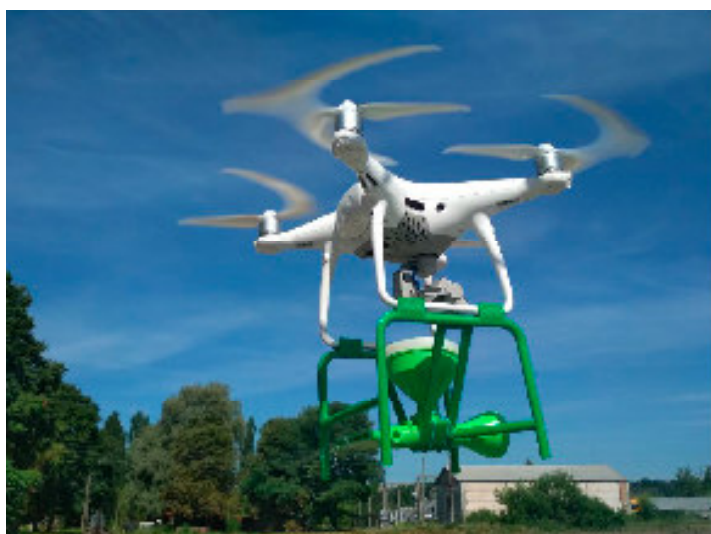
Рис. 4. – Подвес дозирующе-высевающего устройства на квадрокоптер DJI Phantom 4
