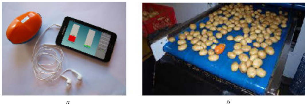
Рис. 1. – Электронный картофель TuberLog от MartinLishman: а – внешний вид TuberLog; б –TuberLog в убранном урожае
