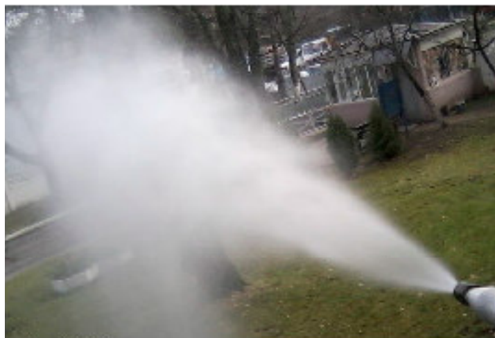
Рис. 2 – Форма струи с максимальным углом распыления ( d_n=1,8\text{мм} , p\geq 12\text{МПа} )
