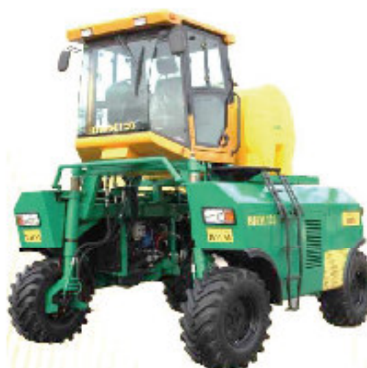
Рис. 4. – Самоходное универсальное высококлиренсное гидрофицированное энергосредство с электронным управлением (СУВЭС)
