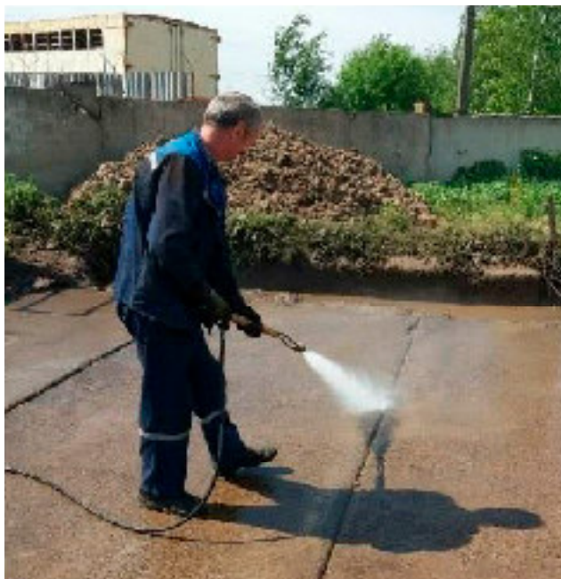
Рис. 3 – Производственные испытания опытного образца брендспойта с насадком, генерирующим кавитацию в струе ( d_n = 1,8 \text{ мм} )
