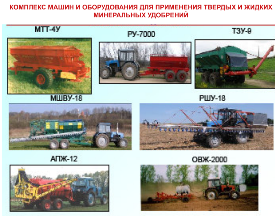
Рис. 2. – Комплекс машин и оборудования для применения твердых и жидких минеральных удобрений
