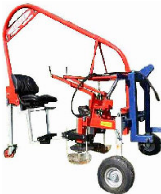
Рис. 8. – Прополочная машина ZUZA 3
