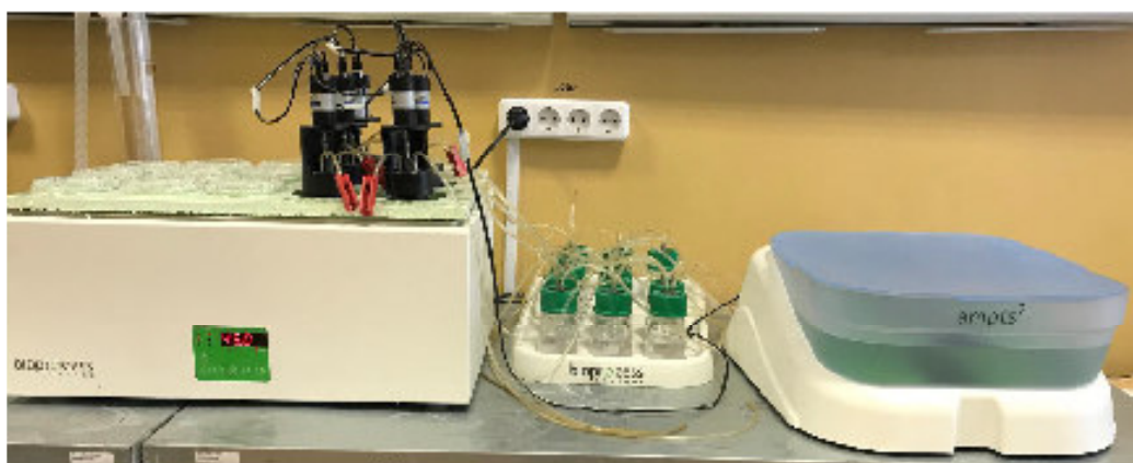
Рис. 1. – Автоматический биопроцессконтроллер по определению выхода метана в процессе анаэробного сбраживания органического сырья
