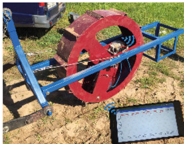
1 – рама; 2 – навесное устройство; 3 – барабан; 4 – пробоотборный зонд; 5 – кронштейн; 6 – тросовый ограничитель; 7 – беспроводной измерительный модуль; 8 – подшипниковый узел; 9 – рым-гайка
