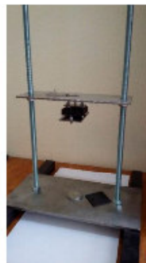
1 – основание; 2 – стойка; 3 – рабочая пластина; 4 – верхняя пластина; 5 – платформа; 6 – груз; 7 – спусковой механизм; 8 – боек; 9 – исследуемое зерно; 10 – предметный столик; 11 – направляющая леска Рис. 1. – Схема (а) и внешний вид (б) стенда для исследования деформации зерна при динамическом воздействии
