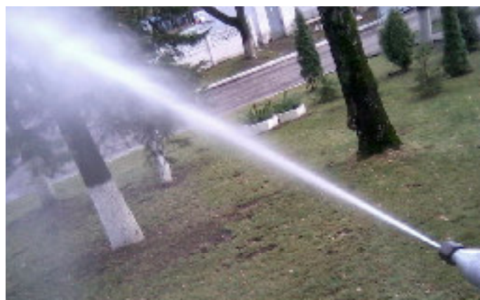
Рис. 1 – Форма струи с минимальным углом распыления ( d_n=1,8 мм, p \geq 12 МПа)
