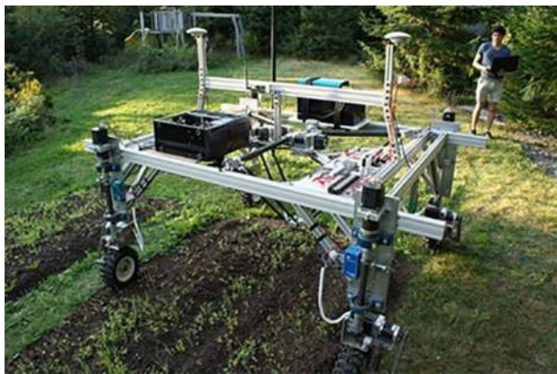
Рис. 7. – Автономный робот для удаления сорняков R2Weed2
