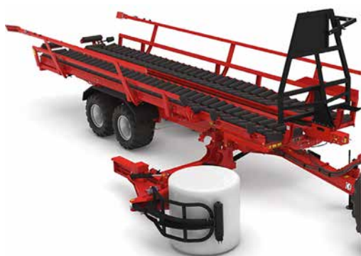
Рис. 4. Этап захвата рулона в вертикальном положении автоматизированным захватывающим устройством
