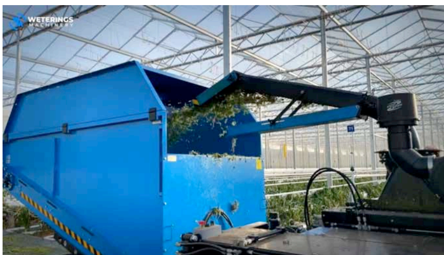
Рис. 8. Подборщик-измельчитель Bio Chopper compact Tier 4 Final motor (TFC03) фирмы Weterings Machinery (Нидерланды): a – подбор органических отходов; б – измельчение и выгрузка отходов в бункер
