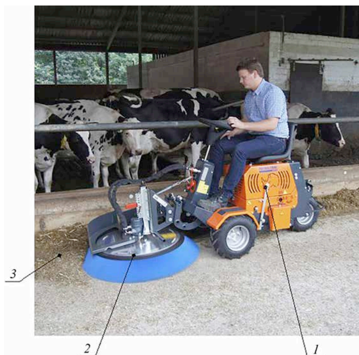
Рис. 5. Самоходный пододвигатель с роторным рабочим органом марки Тгас MINI 3: 1 – энергетическое транспортное средство; 2 – роторный рабочий орган; 3 – кормовой стол
