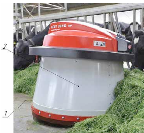
Рис. 8. Роботизированный пододвигатель с роторным рабочим органом марки Juno 100: 1 – кормовой стол; 2 – роботизированный пододвигатель
