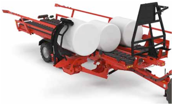
Рис. 10. Этап поворота рулона в горизонтальном положении на 90 градусов
