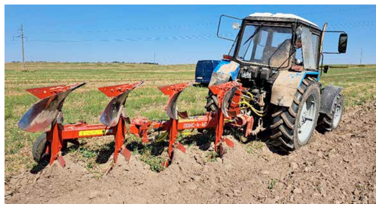
Рис. 3. Плуг ПОНС-4-40: а – в транспортном положении; б – в работе
