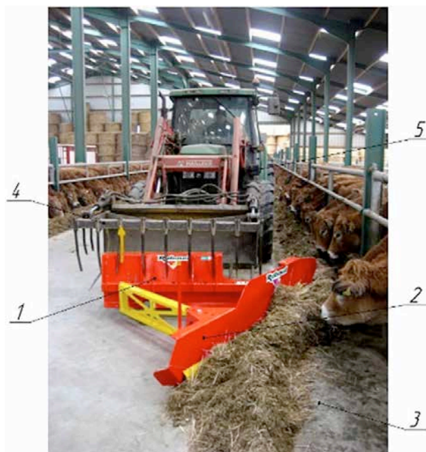
Рис. 7. Прицепной пододвигатель со скреперным рабочим органом марки FOURRAGENET: 1 – прицепное устройство; 2 – скрепер; 3 – кормовой стол; 4 – ковш с вилами; 5 – энергетическое средство (трактор)
