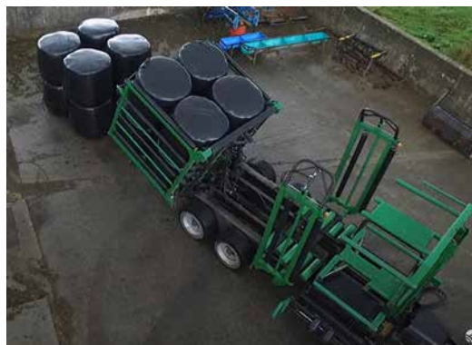
Рис. 9. Разгрузка в скирду рулонов сенажа в полимерной упаковке подборщиком-транспортировщиком CTS-1600
