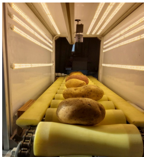
Рис. 5. Система распознавания некондиционных клубней картофеля
