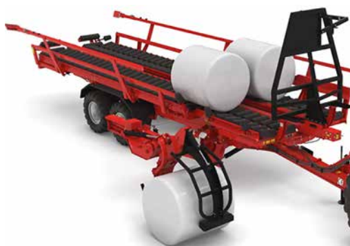
Рис. 8. Этап захвата рулона в горизонтальном положении автоматизированным захватывающим устройством
