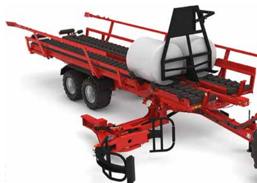
Рис. 7. Этап перемещения рулонов по платформе толкающей стенкой
