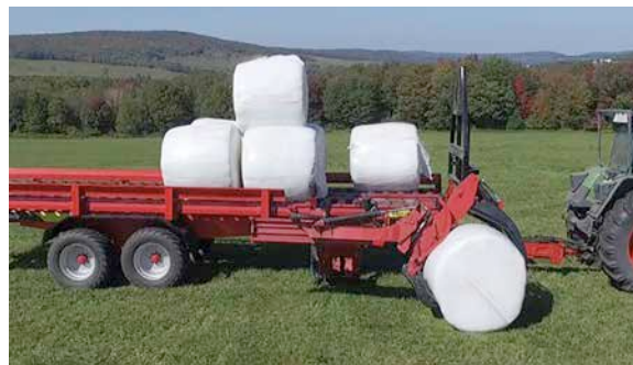
Рис. 5. Подбор рулона сенажа в полимерной упаковке (в горизонтальном положении) подборщиком-транспортёрщиком RBMPRO-1400
