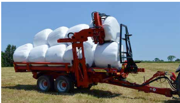
Рис. 6. Загрузка рулона сенажа в полимерной упаковке на платформу на второй ярус подборщиком-транспортировщиком RBMPRO-1400
