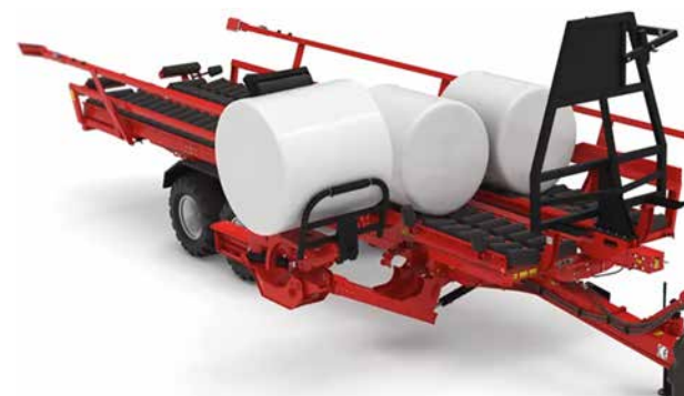
Рис. 9. Этап подъема рулона и опрокидывания его в горизонтальном положении на 135 градусов автоматизированным захватывающим устройством
