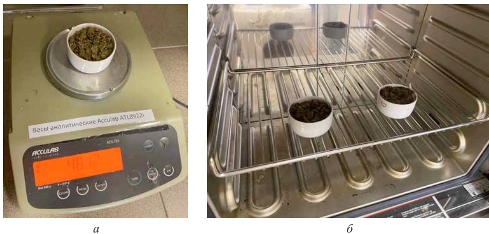
Рис. 3. Процесс определения влажности твердого сепарированного навоза КРС: а – взвешивание тигля с образцом до высушивания с помощью лабораторных весов «Acculab ATL»; б – высушивание образца в сушильном шкафу Memmert basic
