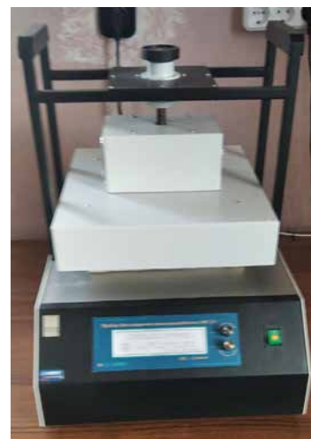
Рис. 6. Определение теплопроводности твердого сепарированного навоза КРС с помощью прибора ПИТ-2,1
