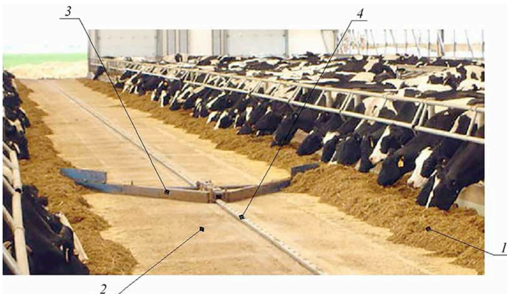
Рис. 2. Стационарный пододвигатель со скреперным рабочим органом марки Dairymaster FEEDMAX: 1 – кормовой стол; 2 – кормовой проезд; 3 – скреперный пододвигатель; 4 – рейка
