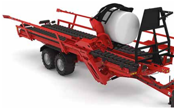
Рис. 11. Этап загрузки рулона на платформу погрузочным рычагом
