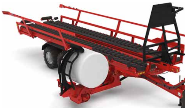
Рис. 5. Этап подъема рулона и опрокидывания его в вертикальном положении на 90 градусов автоматизированным захватывающим устройством
