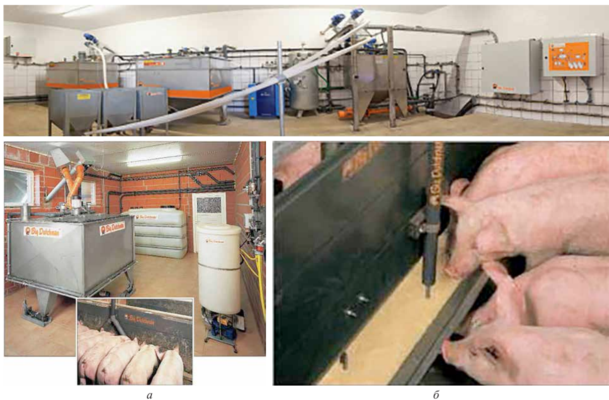
Рис. 1. Общий вид комплекта оборудования для приготовления и кормораздачи влажных кормосмесей HYDROMIX: а – кормокухня; б – сенсор наличия корма в кормушке
