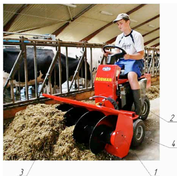
Рис. 3. Самоходный пододвигатель с шнековым рабочим органом марки BOBMAN PRO: 1 – шнековый рабочий орган; 2 – специальное энергетическое средство; 3 – кормосмесь; 4 – кормовой стол
