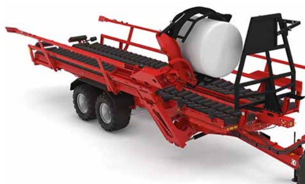
Рис. 6. Этап загрузки рулона на платформу погрузочным рычагом
