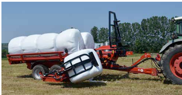
Рис. 4. Подбор рулона сенажа в полимерной упаковке (в вертикальном положении) подборщиком-транспортёрщиком RBMPRO-1400
