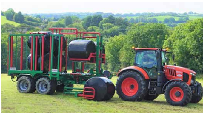
Рис. 8. Подбор рулона сенажа в полимерной упаковке (в горизонтальном положении) подборщиком-транспортировщиком CTS-1600
