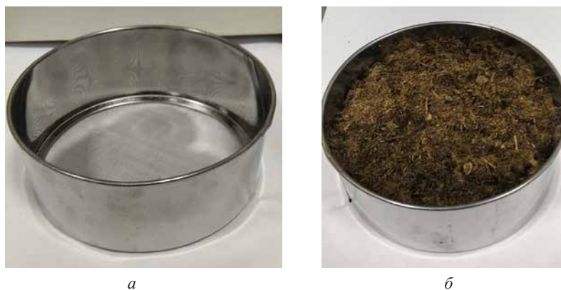
Рис. 4. Сито для материала, исследуемого на влагопоглощение: а – без материала; б – с материалом
