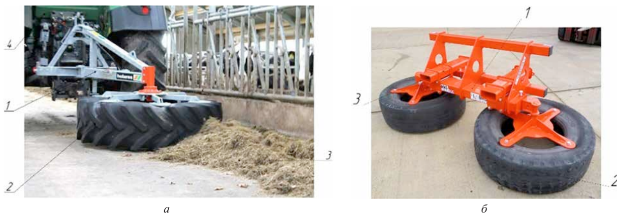
Рис. 6. Навесные пододвигатели с одним или двумя роторными рабочими органами: a – Holaras Hoopman Machines bv: 1 – рама; 2 – рабочее колесо; 3 – кормовой стол; 4 – энергетическое средство (трактор); б – Browns Agricultural: 1 – рама; 2 – покрывка колеса; 3 – прицепной модуль
