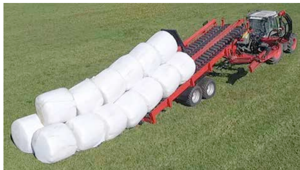
Рис. 7. Разгрузка в скирду рулонов сенажа в полимерной упаковке подборщиком-транспортировщиком RBMPRO-2000
