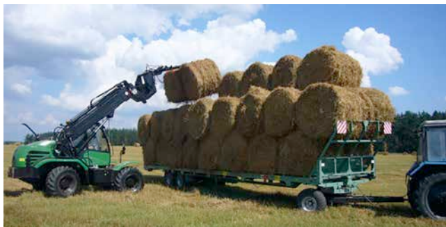
Рис. 1. Загрузка рулонов соломы на платформу для транспортировки кормов ПТК-10 специальным погрузчиком «Амкодор 527»
