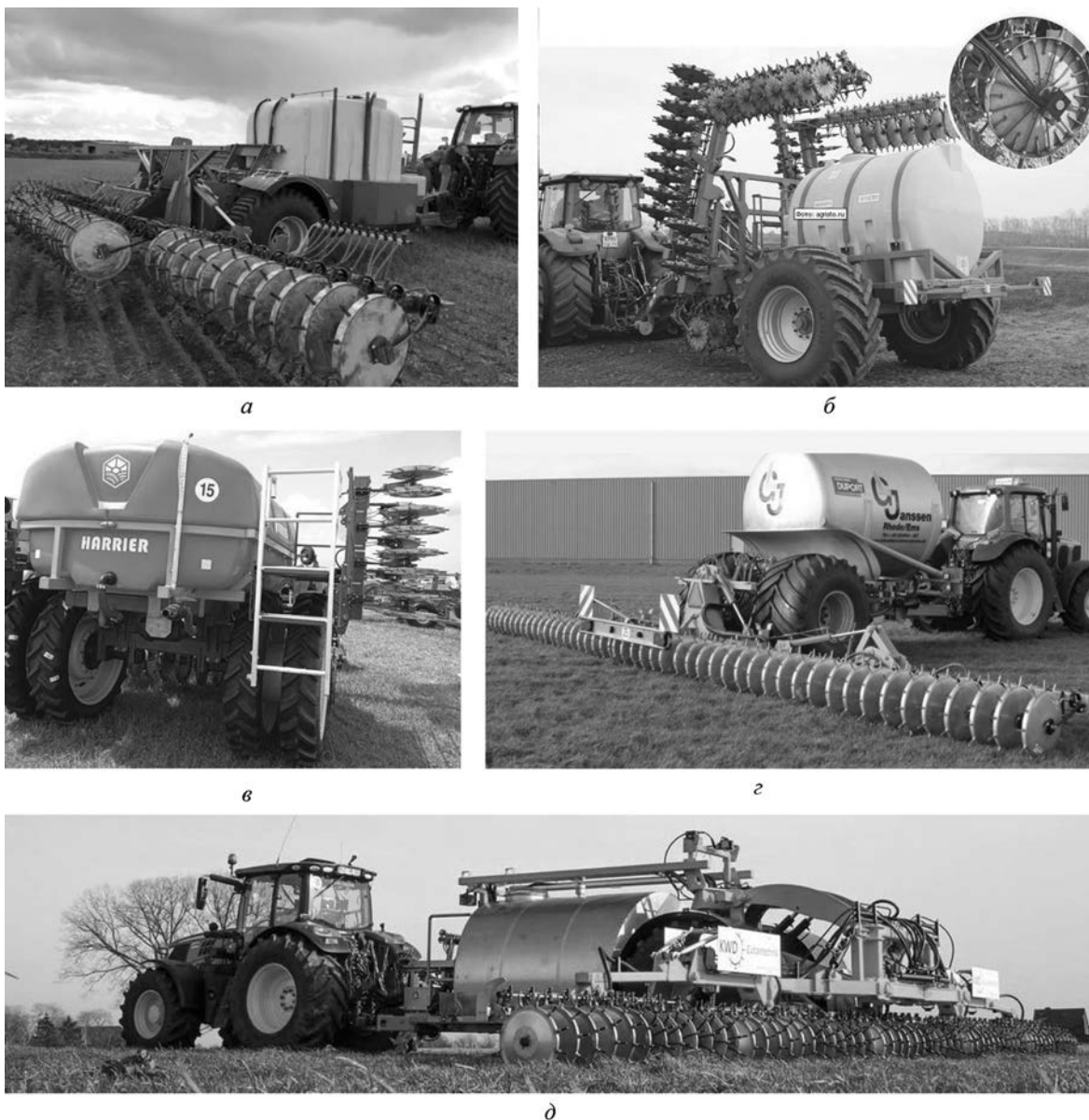
Рисунок 3 – Инъекционные растениепитатели: а – ликвилайзер «Алтай 12000»; б – растениепитатель «ЛиквилайРус»; в – почвенный иньектор ИП-12 Harrier; г – ликвилайзер SW12048 DUPORT; д – иньекторный аппликатор Cultan C15
