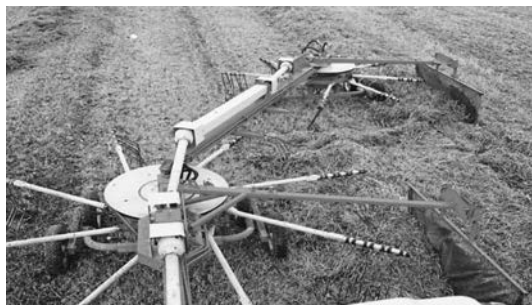
Рисунок 4 – Ротационные грабли-валкователи в работе
