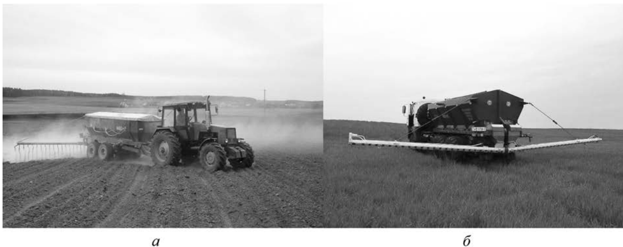
Рисунок 2 – Машины штанговые для внесения химмелиорантов: а – МШХ-9; б – МХС-10
