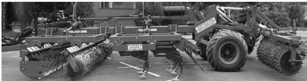
Рисунок 4 – Агрегат почвообрабатывающий многофункциональный АПМ-6 в комплектации с дисковыми и лаповыми рабочими органами
