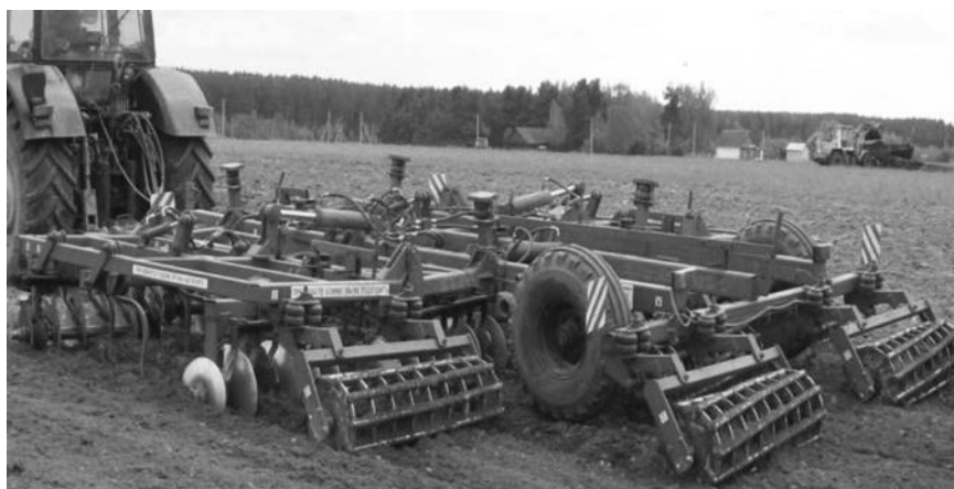
Рисунок 2 – Агрегаты с чизельно-дисковыми рабочими органами: а – чизельно-дисковый культиватор КЧД-6; б – агрегат для минимальной обработки почвы АКМ-6
