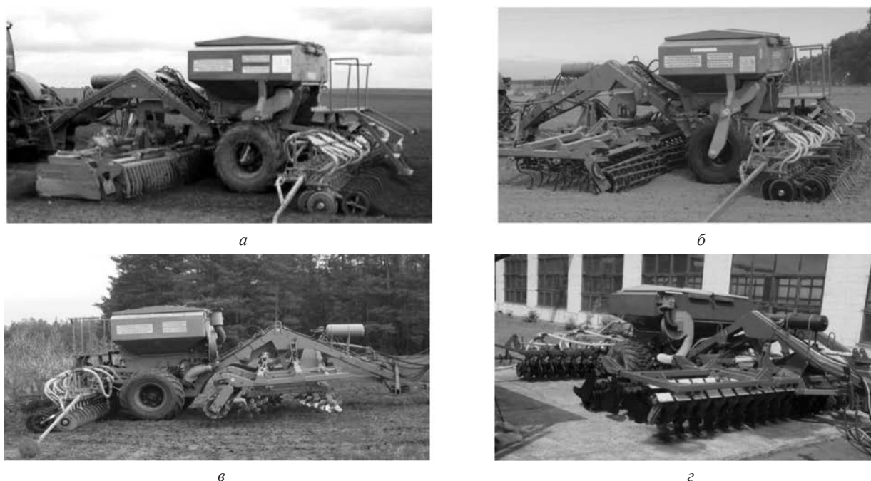
Рисунок 8 – Почвообрабатывающе-посевной агрегат АППА со сменными почвообрабатывающими рабочими органами: а – АППА-6 с активными (роторными) рабочими органами; б – АППА-6-01 с пассивными лаповыми рабочими органами; в – АППА-6-02 с пассивными ножевидными рабочими органами; г – АППА-6-03 с пассивными дисковыми рабочими органами
