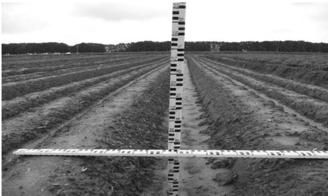
Рисунок 2 – Проведение измерений профиля гряд и агрофизических показателей почвы после посадки картофеля в РУП «НПЦ НАН Беларуси по картофелеводству и плодоовощеводству» (п. Самохваловичи Минского района)
