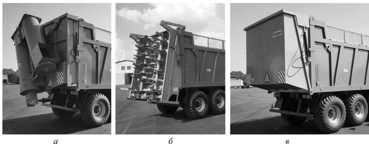
Рисунок 3 – Полуприцеп тракторный специальный со сменными приспособлениями ПСС-20 (ОАО «Вороновская сельхозтехника»): а – полуприцеп с перегрузчиком; б – полуприцеп с разбрасывателем; в – полуприцеп с платформой
