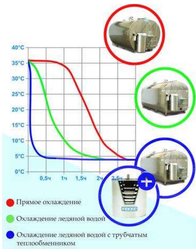
Рисунок 4 – Скорость охлаждения молока в зависимости от способа охлаждения
