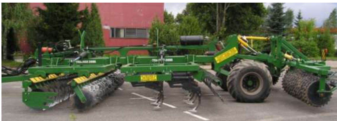
Рисунок 7 – Агрегат почвообрабатывающий многофункциональный АППМ-6 в комплектации: сферические диски + лапы рыхлительные + катки с зубчатыми дисками
