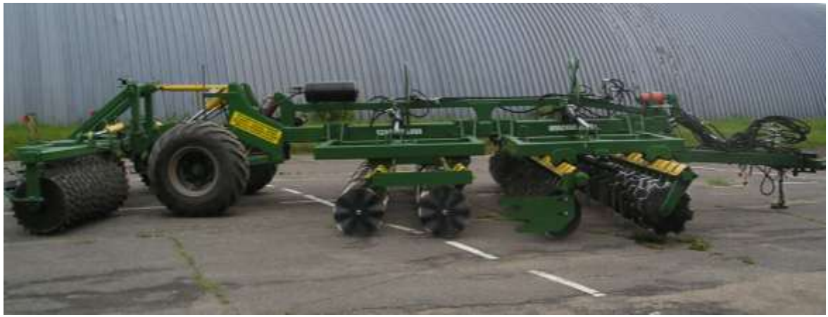
Рисунок 3 – Агрегат почвообрабатывающий многофункциональный АПМ-6 в комплектации: сферические диски + волнистые диски + катки с зубчатыми дисками
