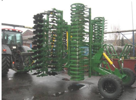
Рисунок 2 – Агрегат почвообрабатывающий дисковый АПД-6
