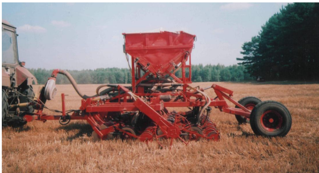
Рисунок 4 – Сеялка зерно-туко-травяная прямого посева СПП-3,6
