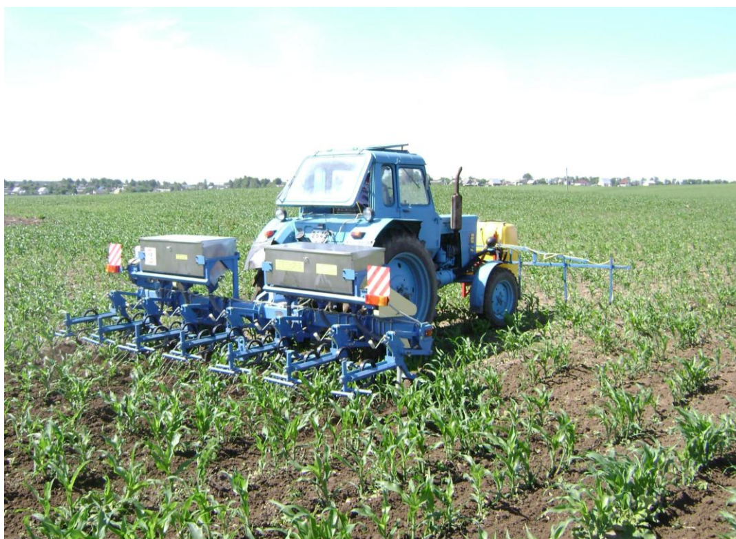
Рисунок 1 – Агрегат для ухода за посевами кукурузы КРК-6
