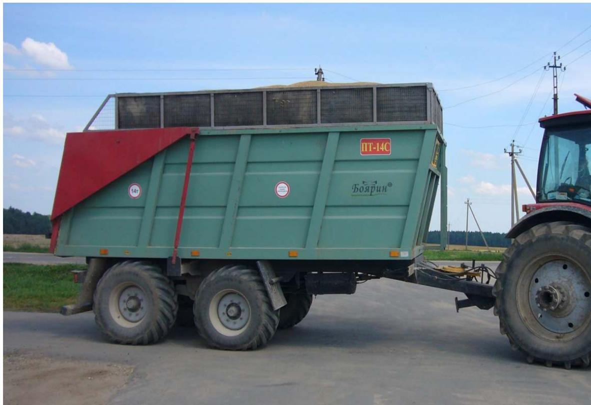
Прицеп тракторный самосвальный ПТ-14С предназначен: для транспортировки и выгрузки сельскохозяйственных грузов различного назначения (силосной и сенажной массы, других измельченных грубых кормов, зерна, комбикормов, корнеклубнеплодов и др.). Также используется для перевозки органических, минеральных удобрений, торфа, песка и других строительных материалов.
