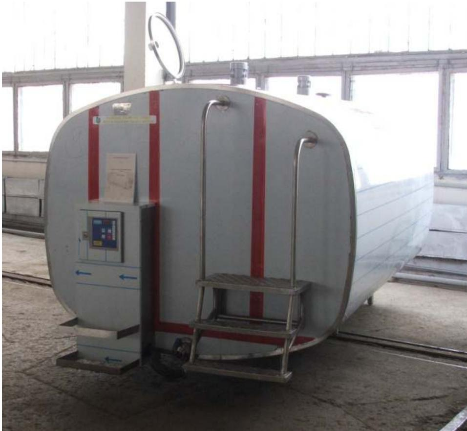
Предназначена для сбора, охлаждения молока от 35 до 4°С и его временного хранения при температуре не выше плюс 5°С до перевозки на дальнейшую переработку.
