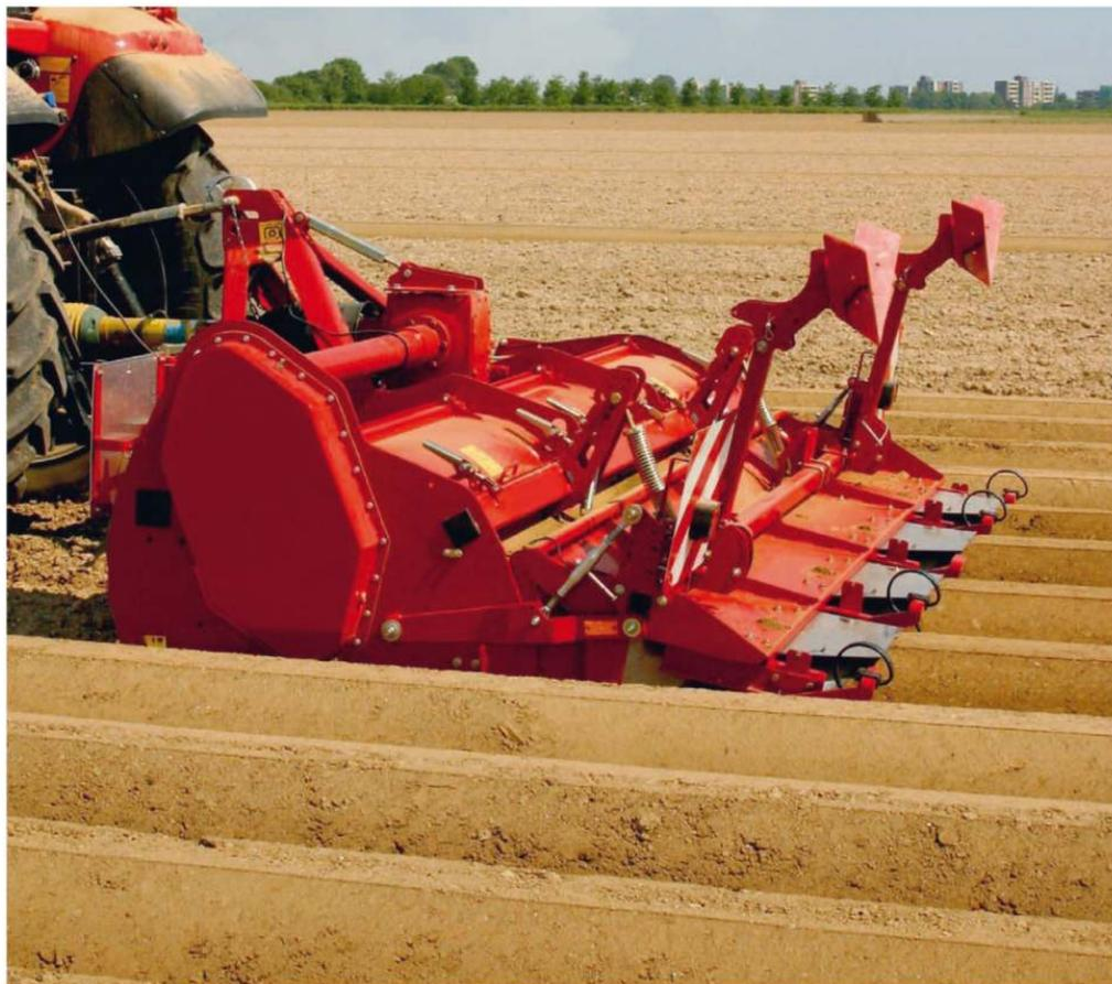
Предназначен для нарезки гребней, рыхления почвы в междурядьях посадок картофеля с одновременным формированием высокопрофильных гребней. При установке дополнительных зубьев применяются для сплошной обработки почвы. Агрегируется с тракторами класса 1,4; 2; 3.
