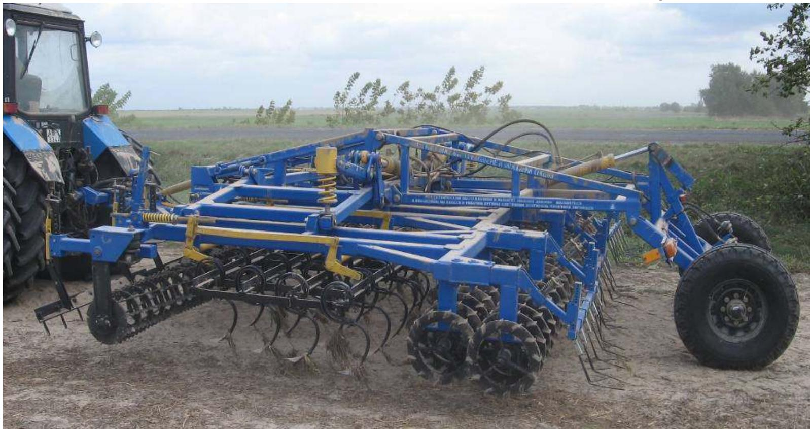
Предназначен для предпосевной обработки минеральных почв (легкосуглинистые, среднесуглинистые, тяжелосуглинистые и глинистые) под посев мелкосеменных культур: льна, свеклы, рапса, трав, а также зерновых и зернобобовых культур.
