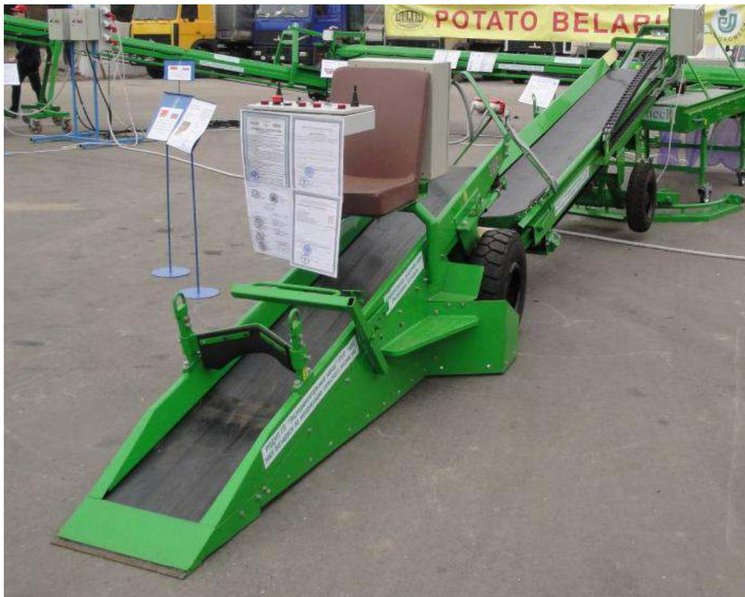
Предназначен для забора сельскохозяйственной продукции и транспортировки ее по телескопическому конвейеру к следующему конвейеру линии или в тару для упаковки.
