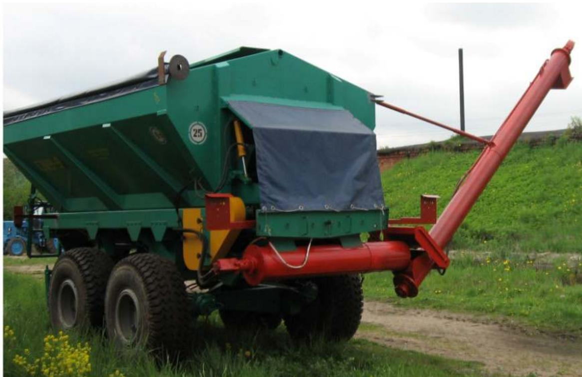
Транспортировщик-загрузчик минеральных удобрений ТЗУ-9 предназначен для транспортирования твердых минеральных удобрений из складских помещений на поле и загрузки удобрений в навесные разбрасыватели.
