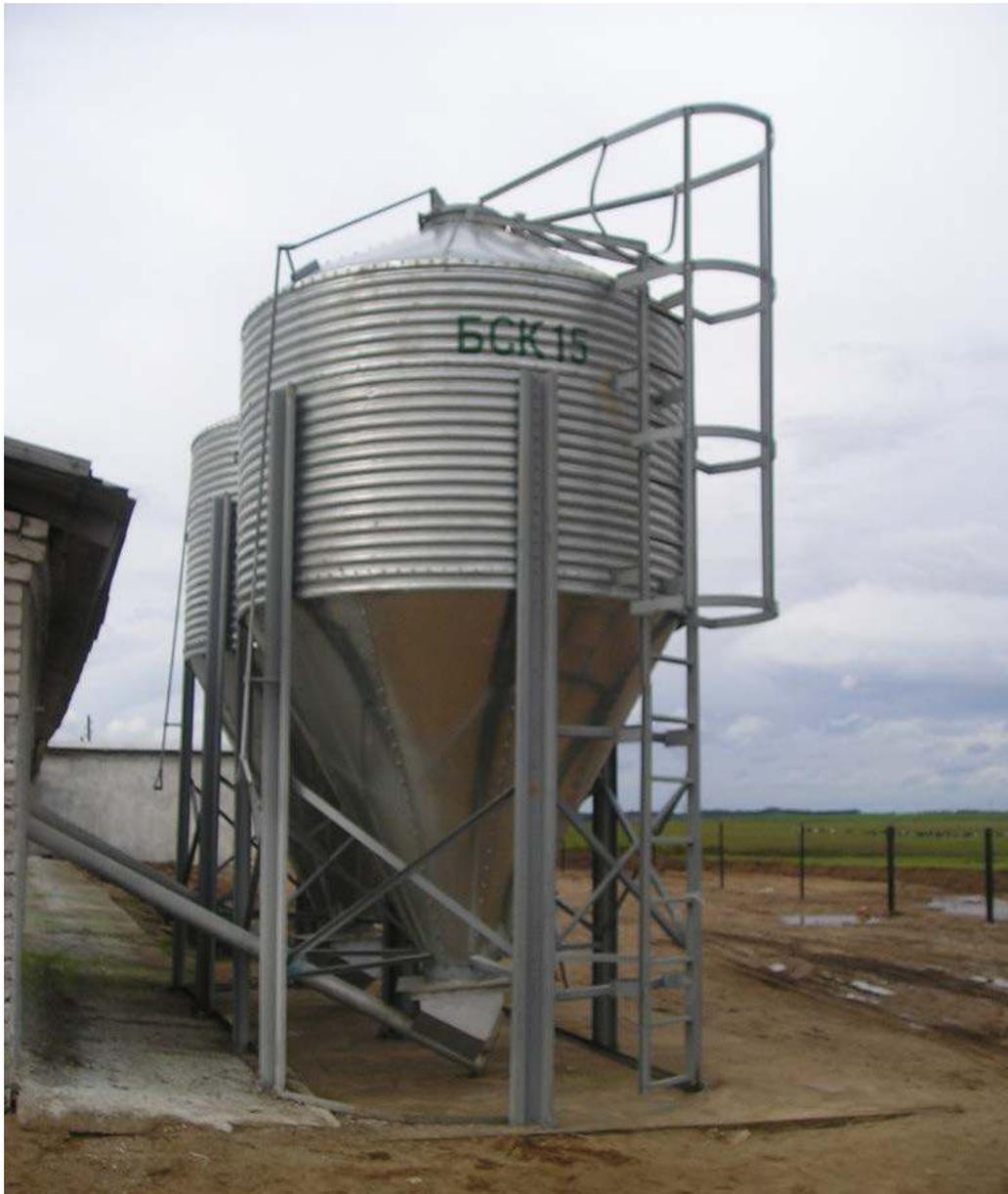
Предназначен для хранения сухих комбикормов и зерна. Применяется для обеспечения цикла кормления кур при их клеточном и напольном содержании на птицефабриках и всех групп свиней на свиноплощадках.
