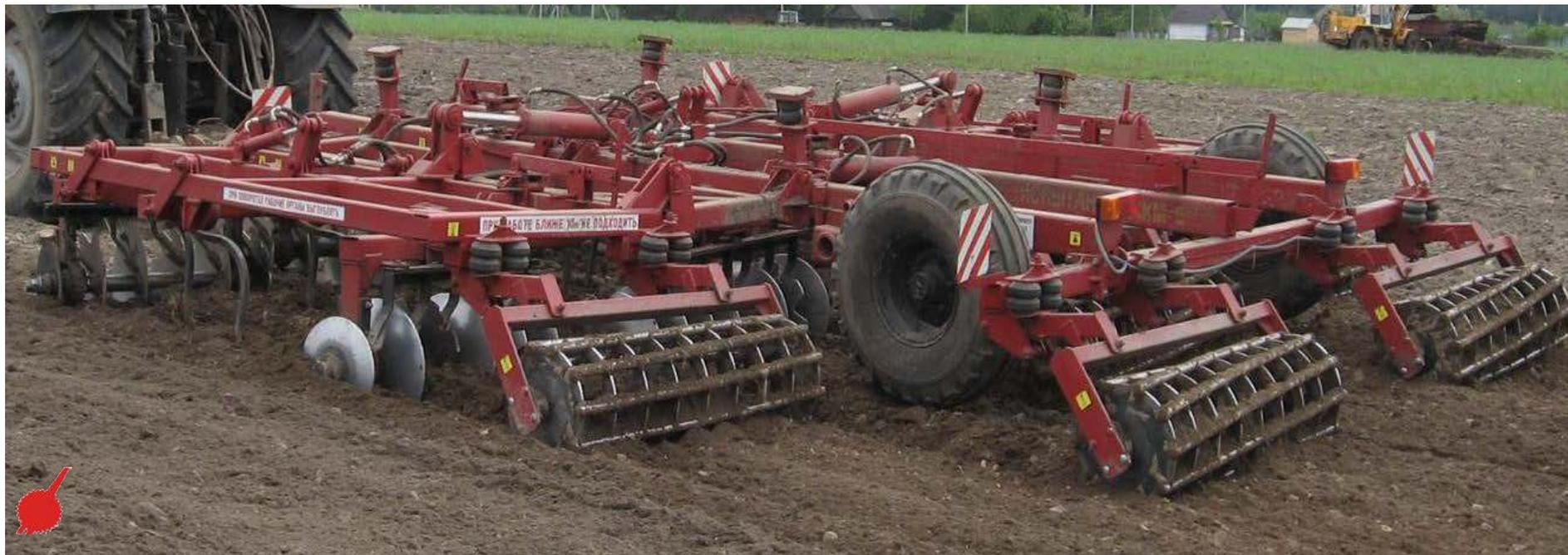
Предназначен для лущения жнивья, полупаровой осенней обработки зяби, осенней обработки полей после уборки кукурузы, свеклы и картофеля, ранневесенней обработки зяби (закрытие влаги и заделка удобрений), для бесплужной подготовки за 2 прохода окультуренных почв под посев озимых зерновых, пожнивных и поукосных культур.
