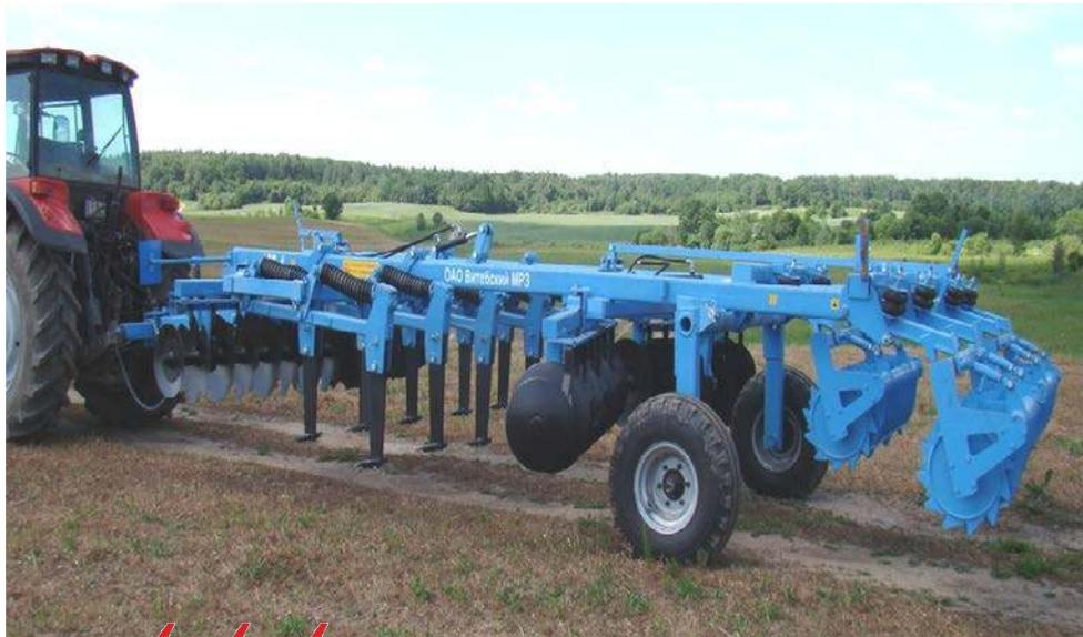
Предназначен для безотвальной обработки тяжёлых почв на глубину до 30 см, лущения жнивья, зяблевой обработки полей после уборки картофеля, кукурузы и свеклы, мульчирования, выравнивания и прикатывания поверхности поля.
