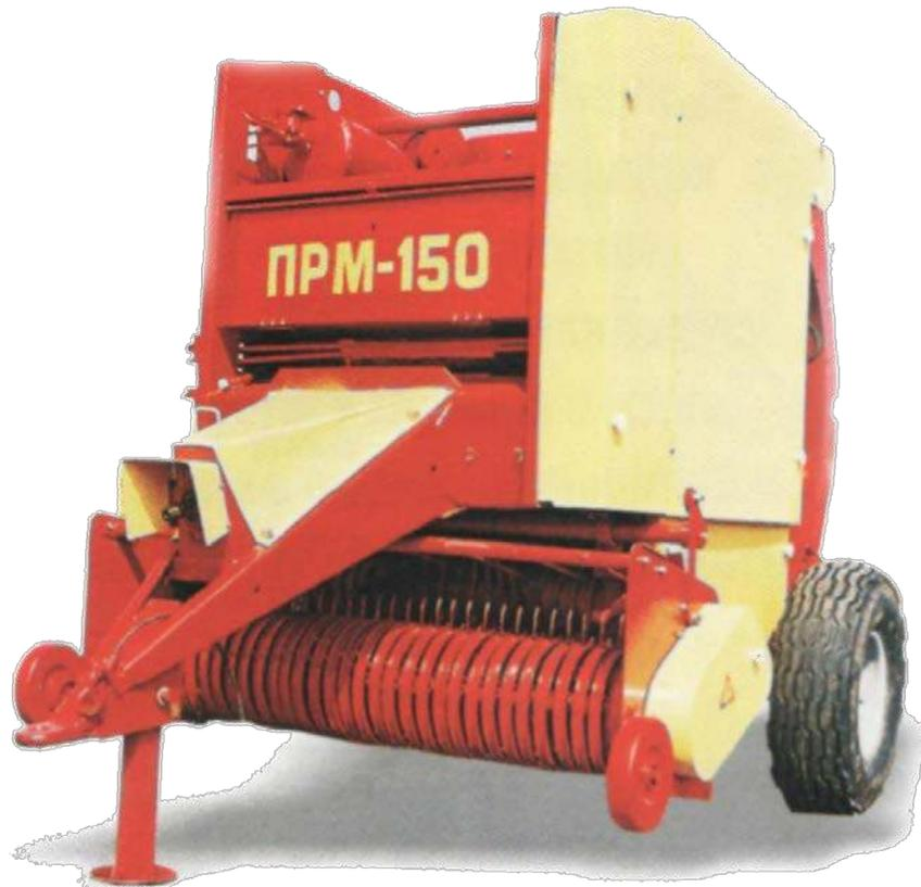
Предназначен для подбора и прессования в рулоны валков сухого сена и провяленной травы, соломы с последующей обмоткой рулона шпагатом.
