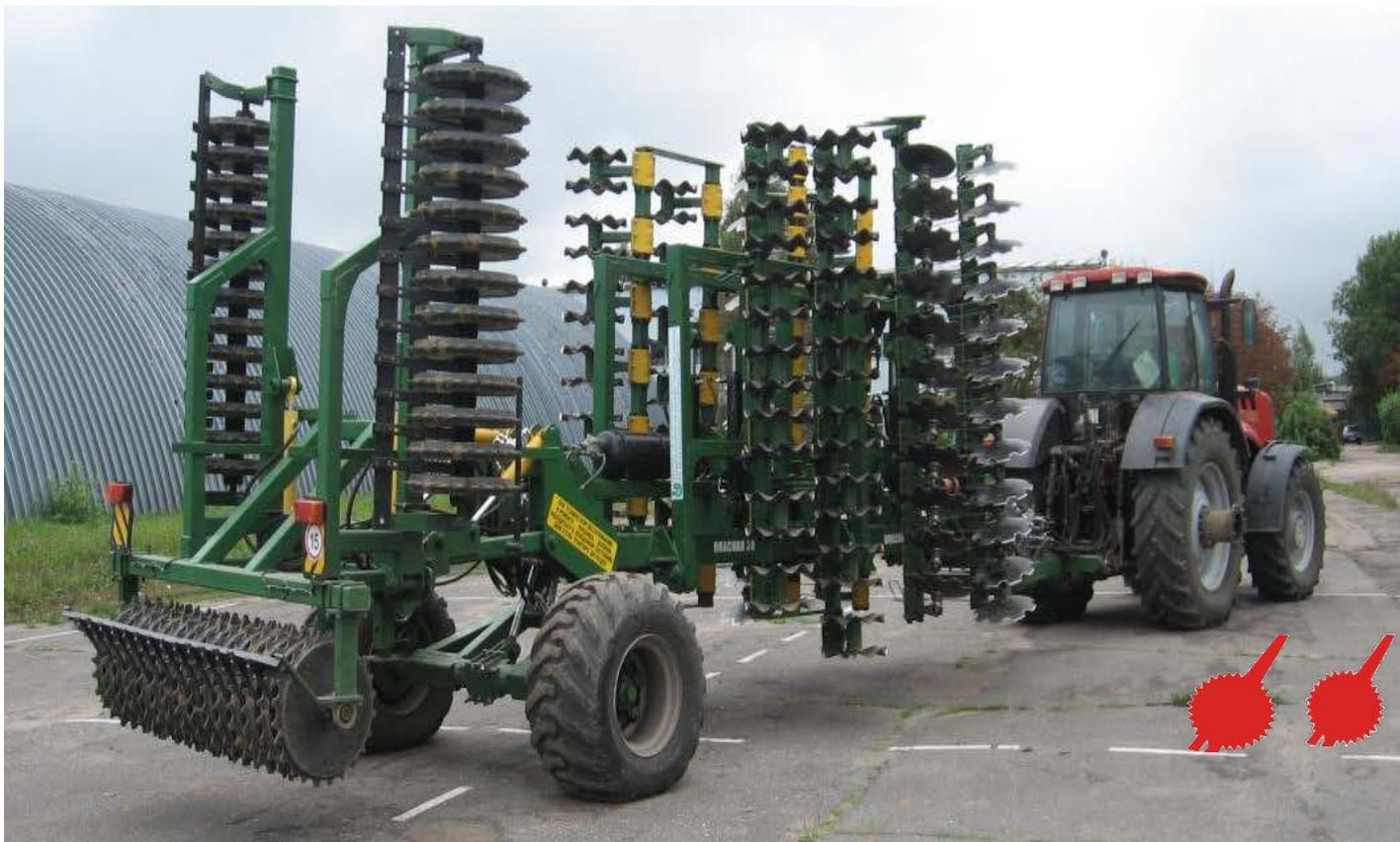
Предназначен для лущения жнивья, мульчирующей обработки почвы под посев поукосных, пожнивных и озимых зерновых культур, обработки пласта однолетних и многолетних трав перед вспашкой, зяблевой обработки полей после уборки картофеля, кукурузы, свеклы, ранневесеннего выравнивания зяби и заделки органических и минеральных удобрений, предпосевной обработки почвы под посев зерновых, зернобобовых, картофеля, кукурузы, свеклы, льна и трав
