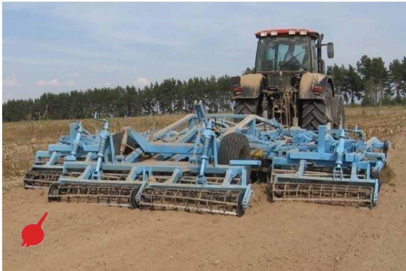
Предназначен для лущения стерни, предварительной подготовки почвы под посев поукосных и пожнивных культур, обработки полей после уборки картофеля и кукурузы, полупаровой обработки зяби и заделки минеральных удобрений.
