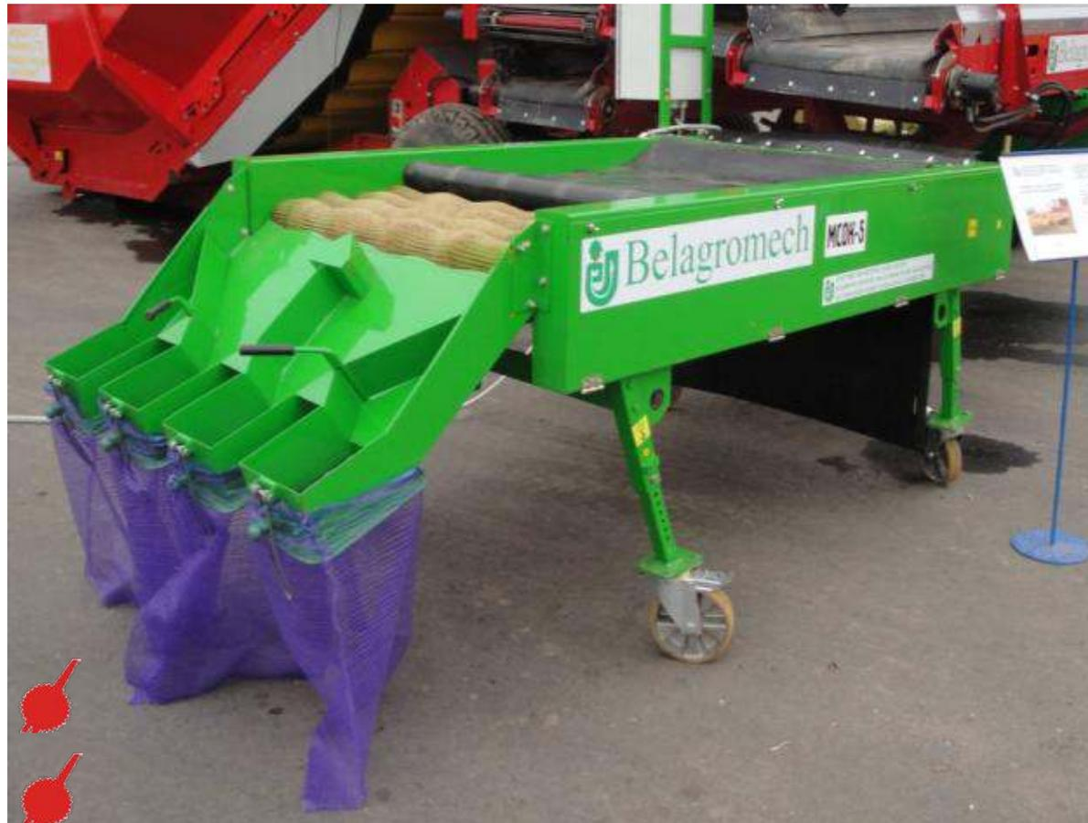
Предназначена для предреализационной подготовки картофеля, с поставкой его к месту реализации без дополнительной доработки. Машина обеспечивает качественное отделение почвы от картофеля без повреждения кожуры. Привод рабочих органов машины от электропривода переменного тока 380 В.
