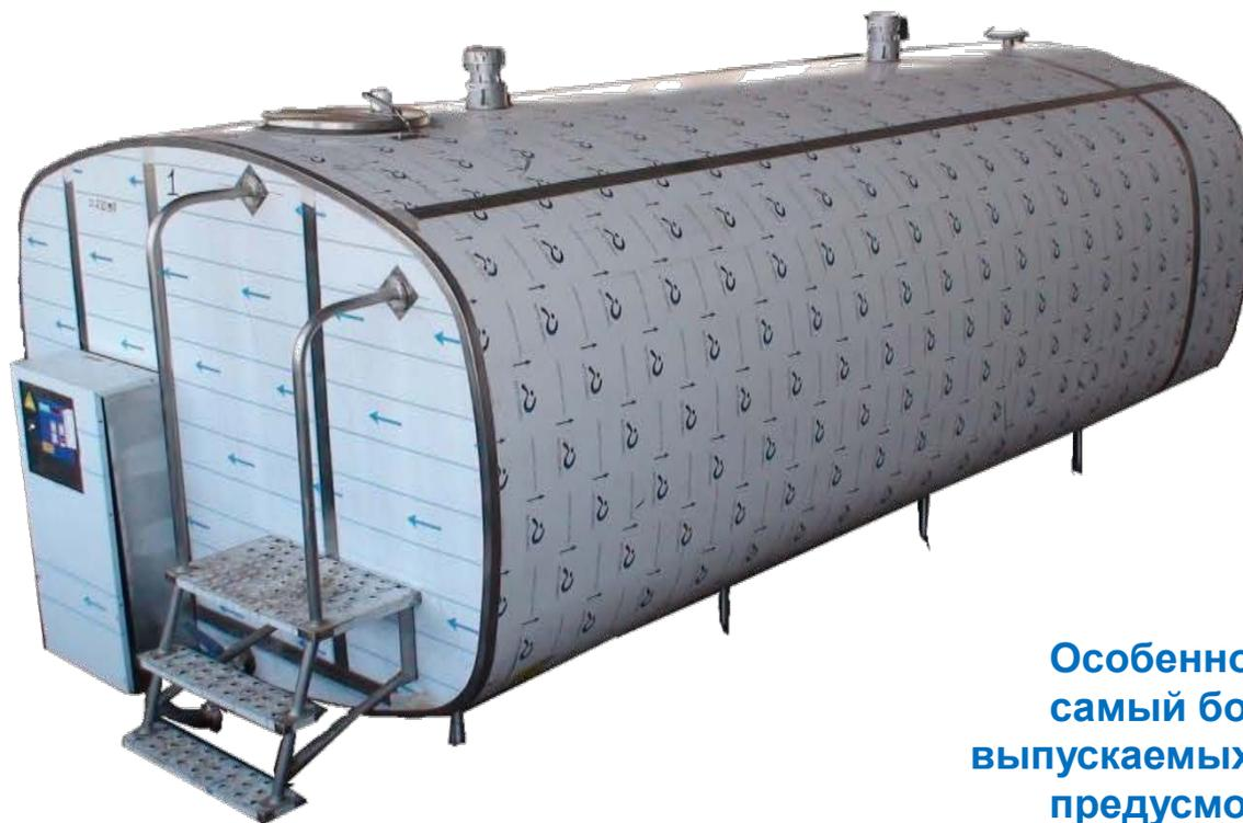
Предназначена для сбора, охлаждения молока от 35 до 4°С и его временного хранения при температуре не выше плюс 5°С до перевозки на дальнейшую переработку. Рассчитана на прием молока четырех удоев. Установка комплектуется рекуператором тепла, осуществляющим в процессе охлаждения молока нагрев воды на технологические нужды, и системой автоматической промывки.
