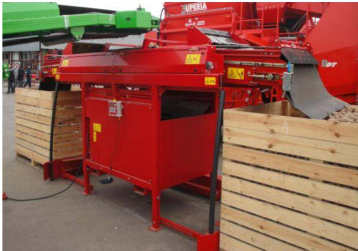
Предназначен для автоматического заполнения контейнеров. Благодаря длинному подвижному укладчику с гидроприводом уменьшаются степени падения продукта при заполнении контейнеров. При заполнении одного контейнера – лента автоматически меняет своё направление и заполняет контейнер на противоположной стороне, при этом исключается его переполнение.
