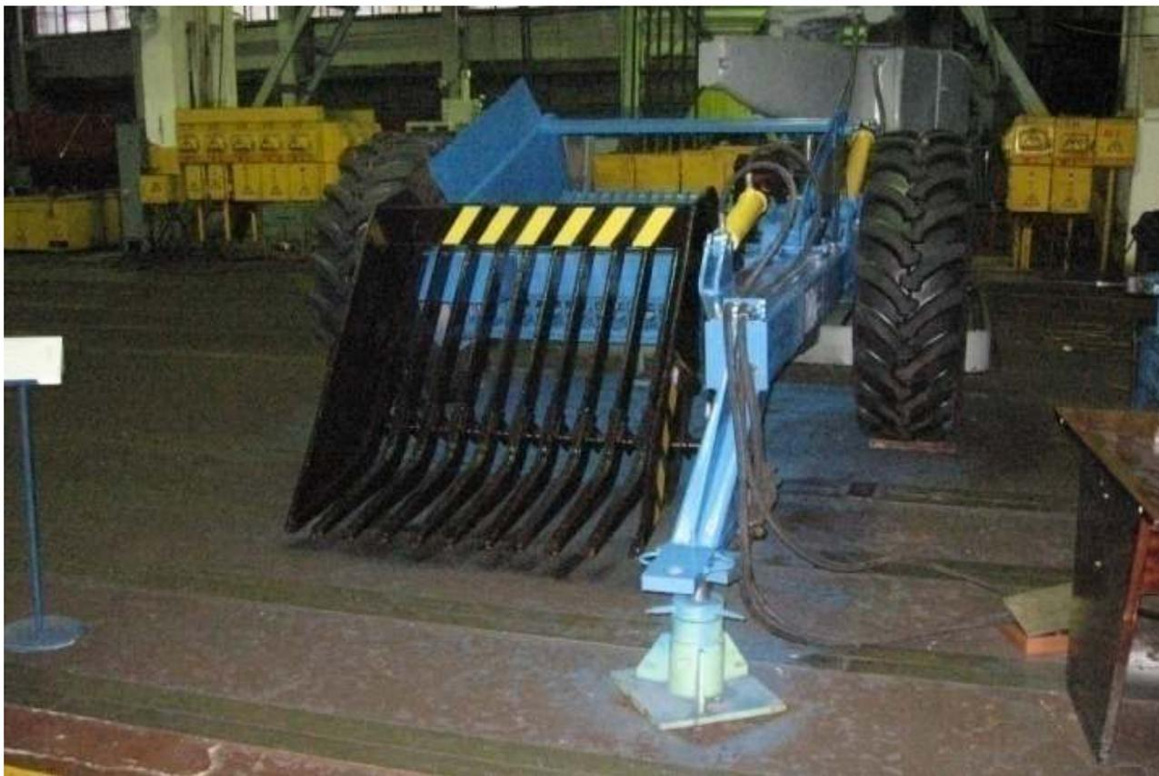
Предназначен для сбора поверхностных и погруженных до 0,1 м в почву камней размером от 30 до 70 см на старопахотных минеральных почвах, свободных от сельскохозяйственных культур в весенний, летний и осенний периоды.
