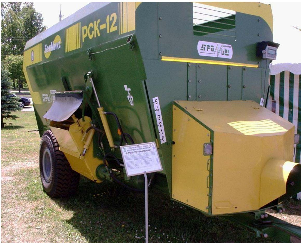
**Предназначен** для измельчения, смешивания кормов из нескольких компонентов, транспортировки и раздачи их в кормушки или на кормовой стол.
