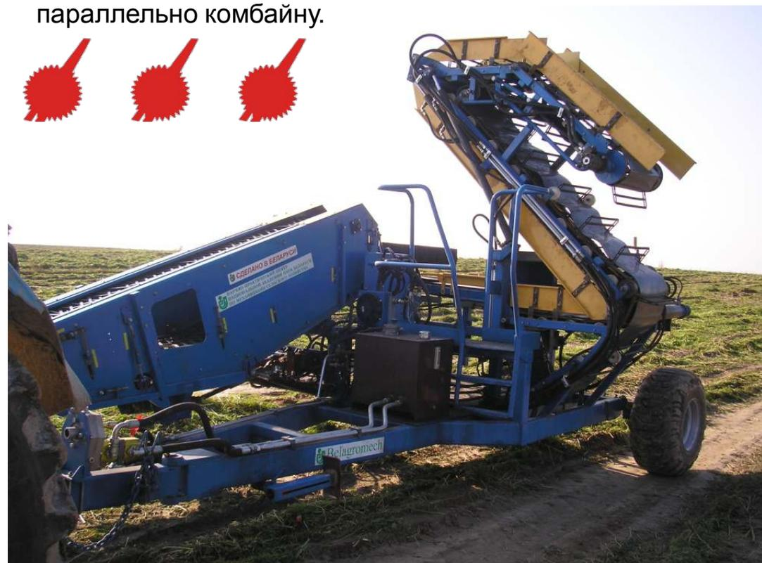
Отличительными особенностями машины является наличие автономной гидравлической системы и системы контроля синхронного движения основных рабочих органов комбайна и движения трактора.
