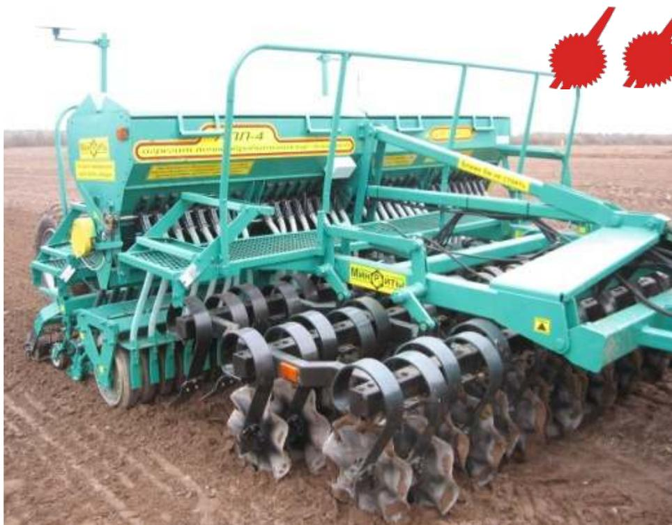
Предназначен для совмещения предпосевной обработки почвы с посевом льна и других культур (рапс озимый и яровой, редька масличная, горчица, травы, в т.ч. в виде травосмеси, зерновых), аналогичных по норме высева и глубине заделки семян, с одновременным внесением стартовой дозы гранулированных минеральных удобрений.
