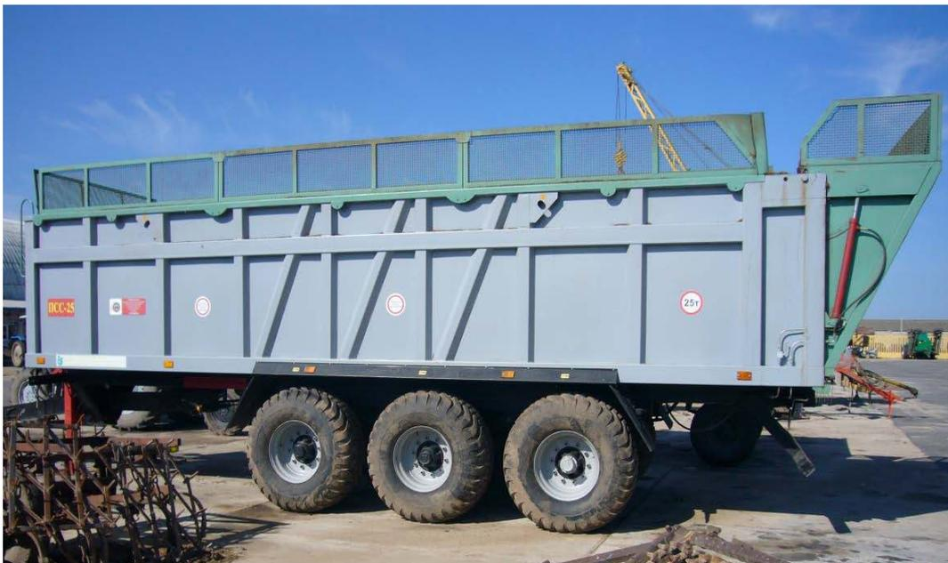
Предназначен: для транспортировки и выгрузки силосной, сенажной массы и других измельченных грубых кормов, а также корнеплодов – базовая комплектация кузова с гидрофицированным клапаном; для транспортировки и перегрузки зерна, всех видов комбикормов и других сыпучих концентрированных кормов – комплектация с перегрузчиком; для транспортировки и внесения органических удобрений, торфа и других подобных материалов – комплектация с разбрасывателем двухдисковым.
