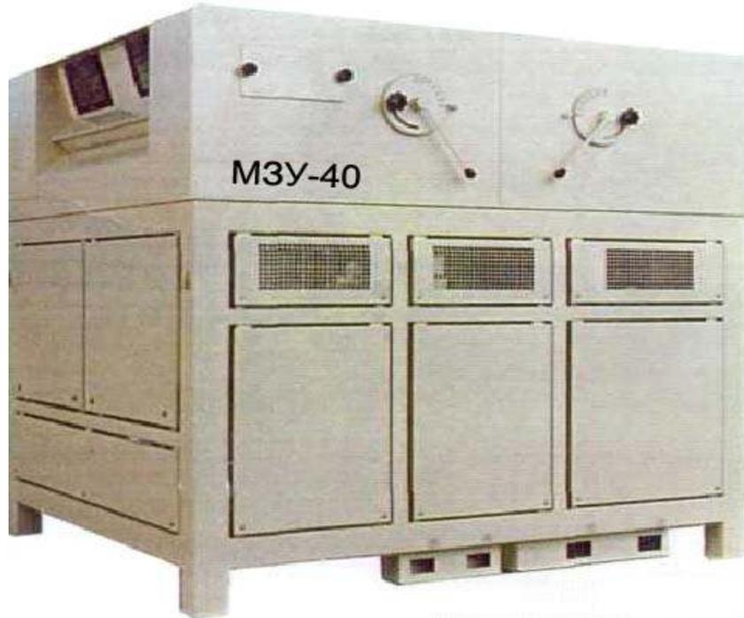
Предназначена для предварительной, первичной и вторичной очистки зерна и семян зерновых колосовых, зернобобовых, крупяных культур и рапса. Используется в составе зерноочистительно-сушильных комплексов и отдельных линий.
