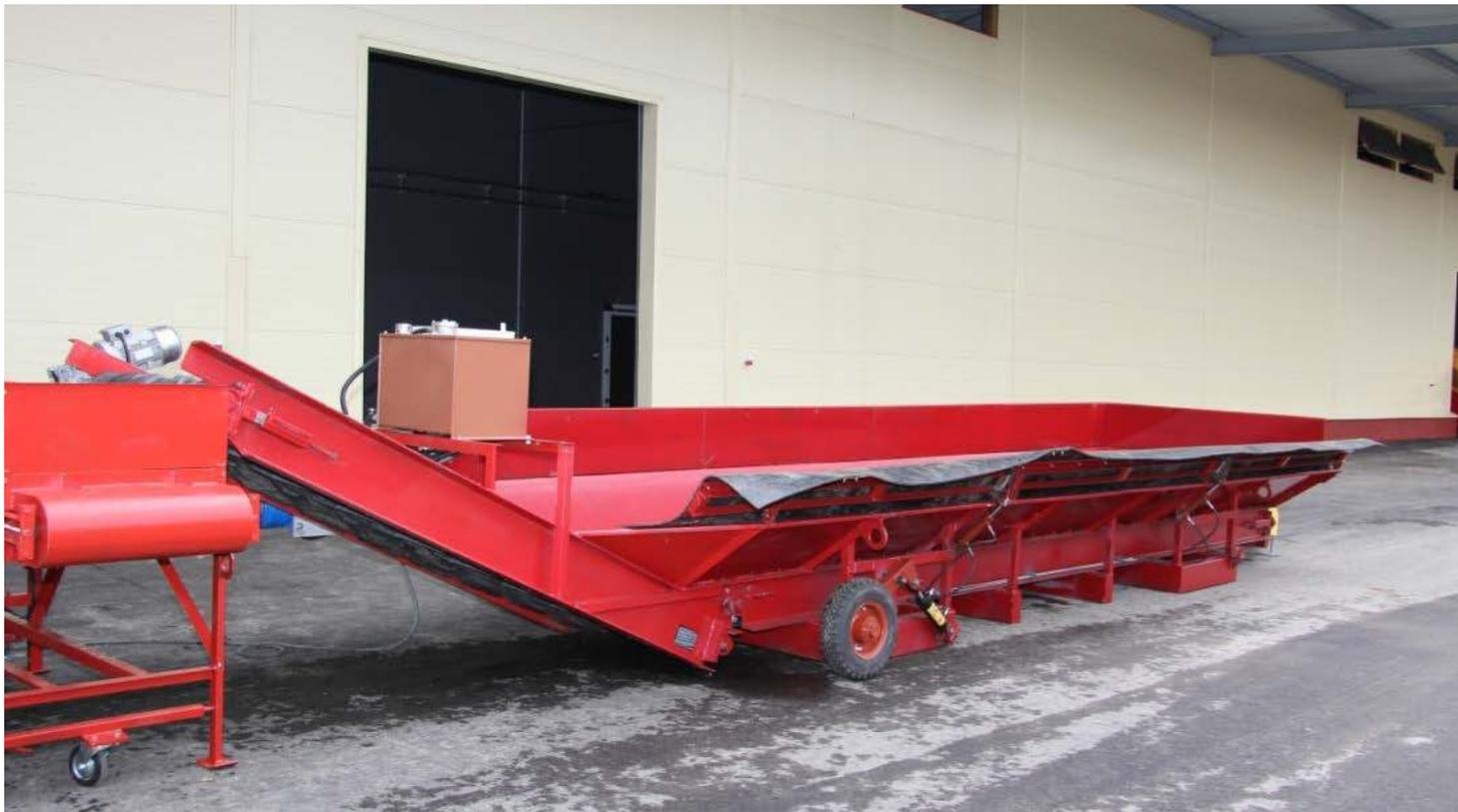
Предназначен для приема вороха корнеклубнеплодов и подачи продукции на конвейер с последующей загрузкой в хранилище или на сортировальный пункт
