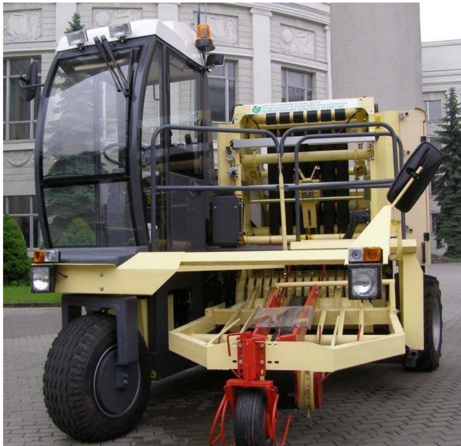
Предназначен для подъема тресты с прессованием в рулоны цилиндрической формы, с прокладкой двух нитей шпагата по всей длине ленты льна и последующей внешней обвязкой.
