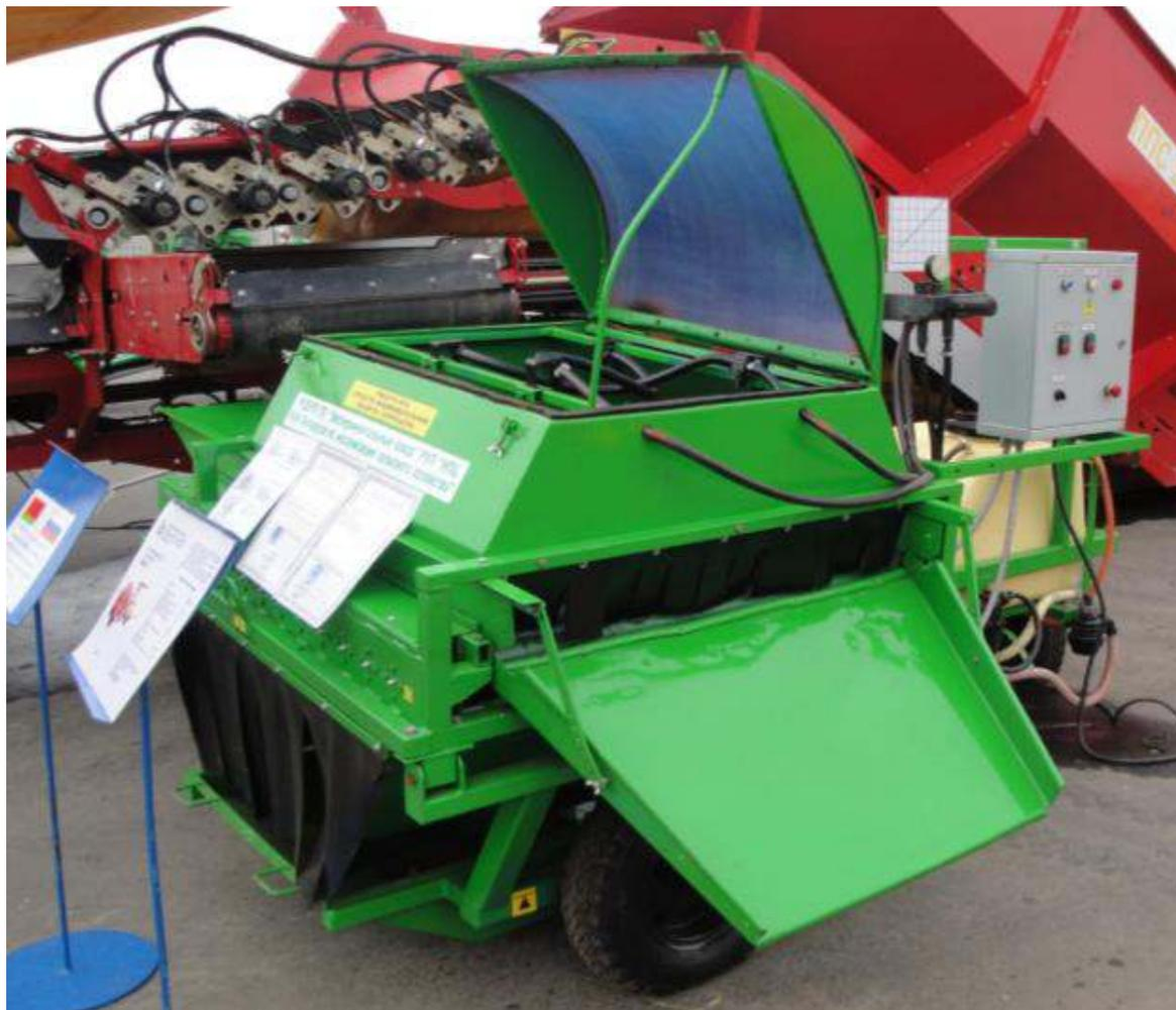
Предназначен для обработки клубней картофеля защитными и защитно-стимулирующими веществами перед посадкой или закладкой на хранение. Может встраиваться в любые технологические линии обработки картофеля.
