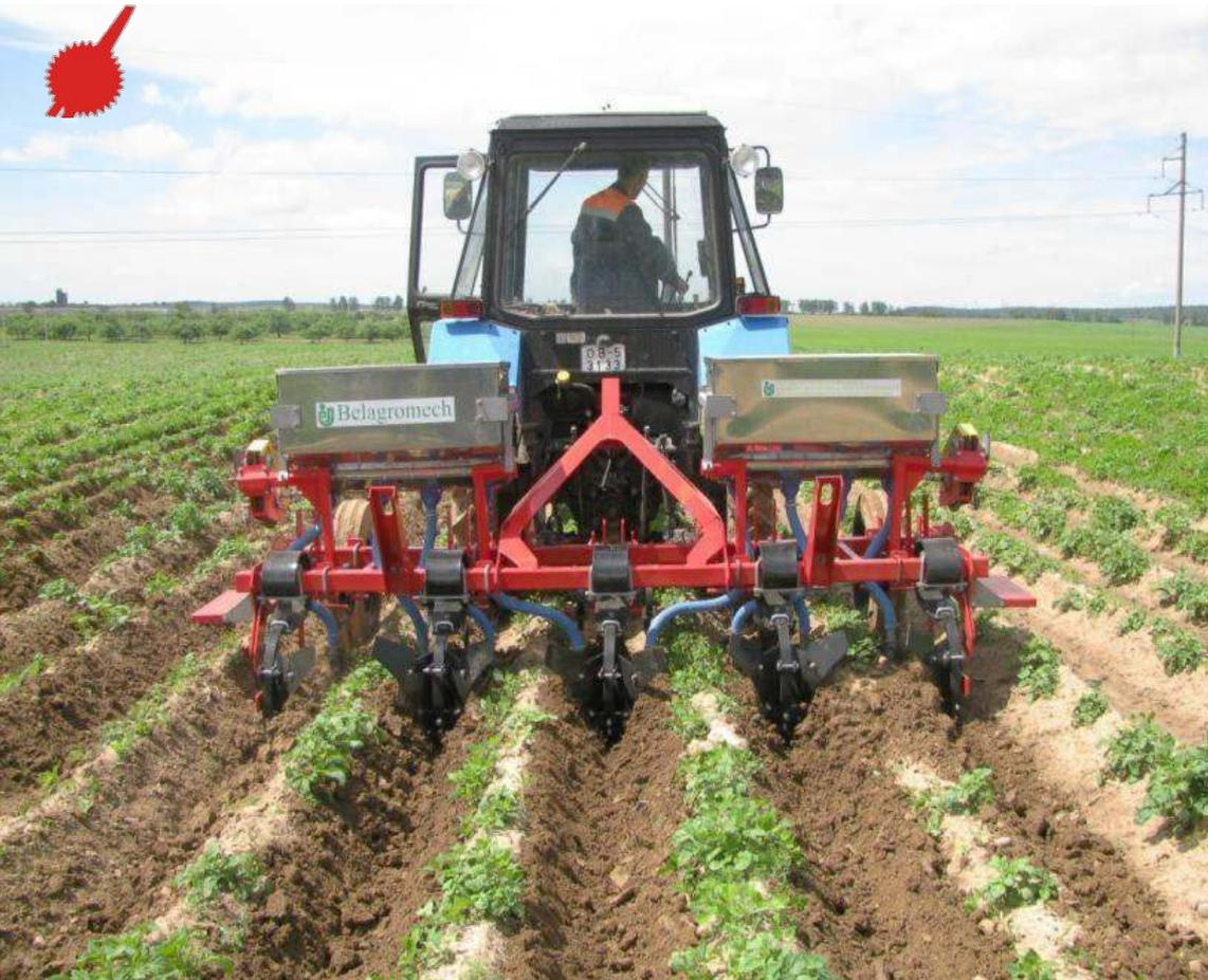
Предназначен для возделывания картофеля с междурядьями 70-90 см, обеспечивающего за один проход качественное формирование объемных гребней, рыхление междурядий и внутрпочвенное внесение минеральных удобрений. Агрегируется с тракторами класса 1,4 и 2.
