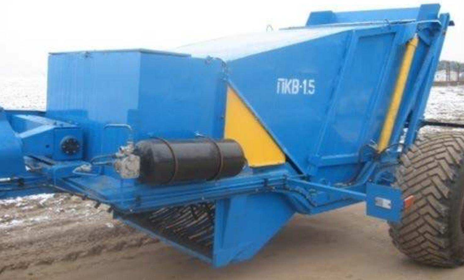
Предназначена для сбора камней из валков размером от 5 до 30 см на старопахотных минеральных почвах, свободных от сельскохозяйственных культур в весенний, летний и осенний периоды и вывозки их к месту складирования или перегрузки в транспортное средство.
