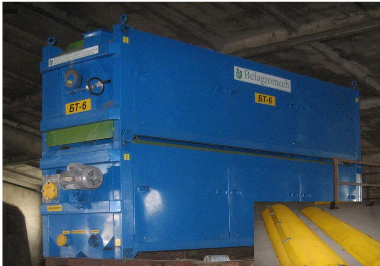
Предназначен для выделения из зернового (семенного) материала зерновых колосовых, зернобобовых, крупяных культур и рапса примесей, отличающихся по длине от зёрен основной культуры, прошедшего первичную (вторичную) очистку на воздушно-решётных машинах.
