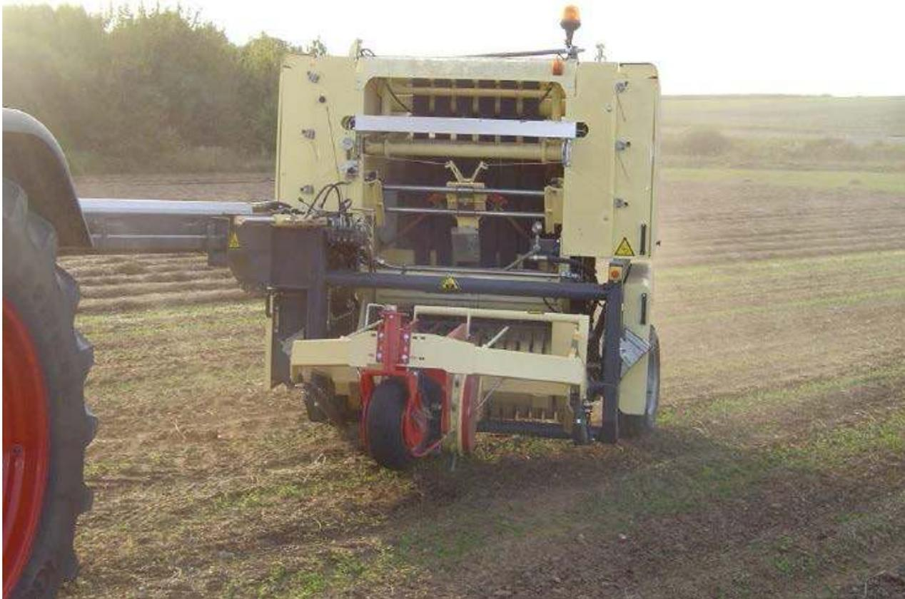
предназначен для подъема льнотресты с прессованием в рулоны цилиндрической формы, с прокладкой двух нитей шпагата в рулоне и последующей внешней обвязкой. Агрегатируется с тракторами тягового класса 2,0.
