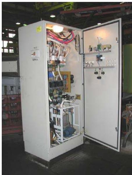
Предназначена для обеспечения процесса непрерывно-последовательной и одновременной заковки деталей сельхозагрегатов. Служит для замены физически и морально устаревшего индукционного оборудования на основе ламповых преобразователей частоты мощностью до 100 кВт с частотой 44-66 кГц.
