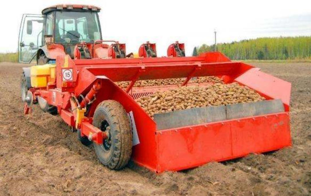
Предназначена для рядковой посадки непророщенных клубней картофеля на всех типах почв с междурядьями 70, 75 и 90 см с одновременным протравливанием клубней и внесением минеральных удобрений.
