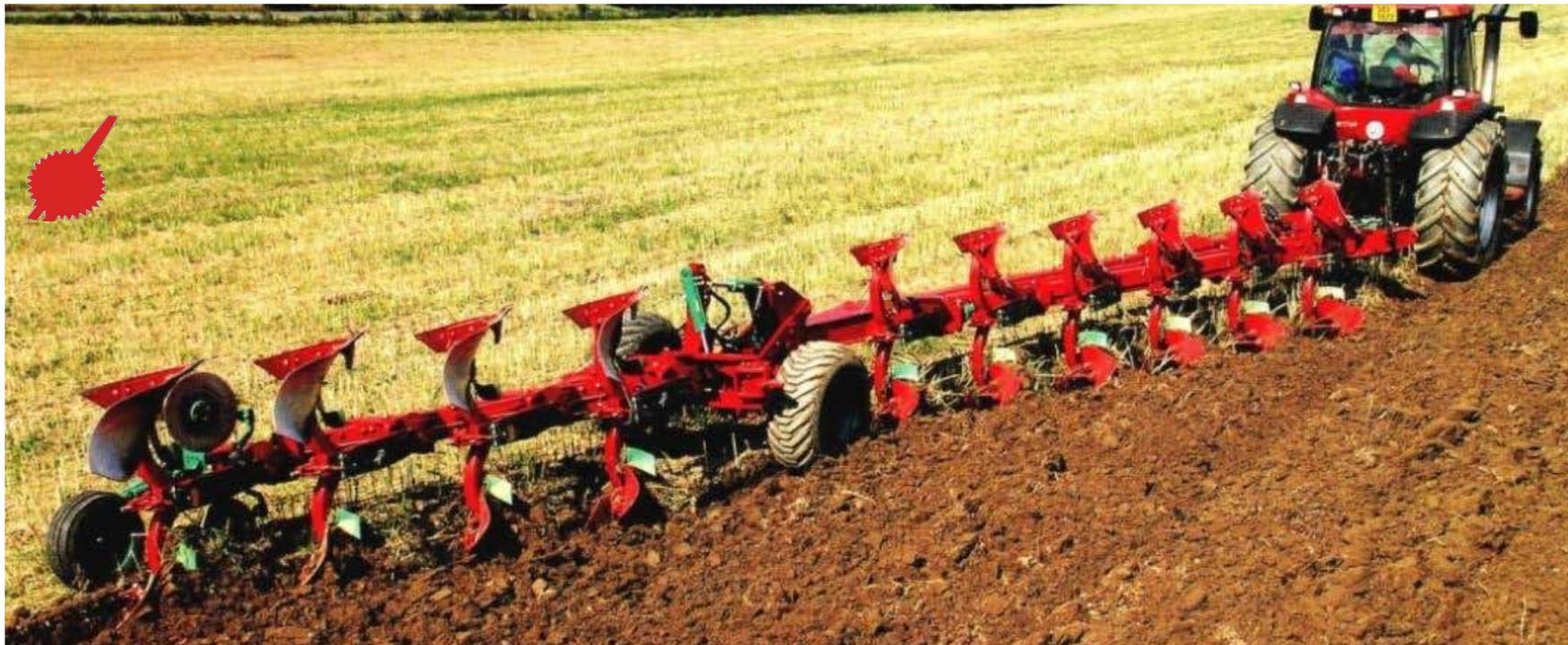
Предназначен для гладкой вспашки почв с удельным сопротивлением до 0,09МПа, в том числе засоренных камнями и другими препятствиями на глубину до 27 см с дополнительной обработкой пласта почвы.
