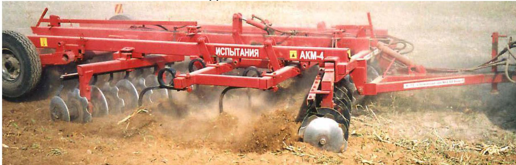
Предназначен для лущения жнивья, полупаровой осенней обработки зяби, осенней обработки полей после уборки кукурузы, свеклы и картофеля, ранневесенней обработки зяби (закрытие влаги и заделка удобрений), для бесплужной подготовки за 2 прохода окультуренных почв под посев озимых зерновых, пожнивных и поукосных культур.
