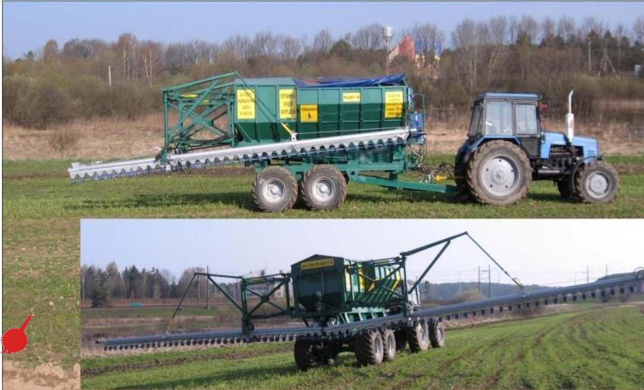
Предназначена для транспортирования и высокоточного поверхностного внесения простых и смешанных минеральных удобрений как основных, так и подкормочных доз.
