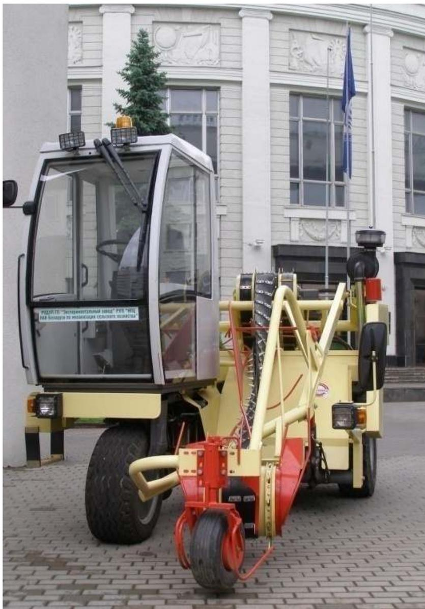
Предназначен для оборачивания льносолумы с целью ее естественной сушки и улучшения условий процесса вылежки в тресту.
