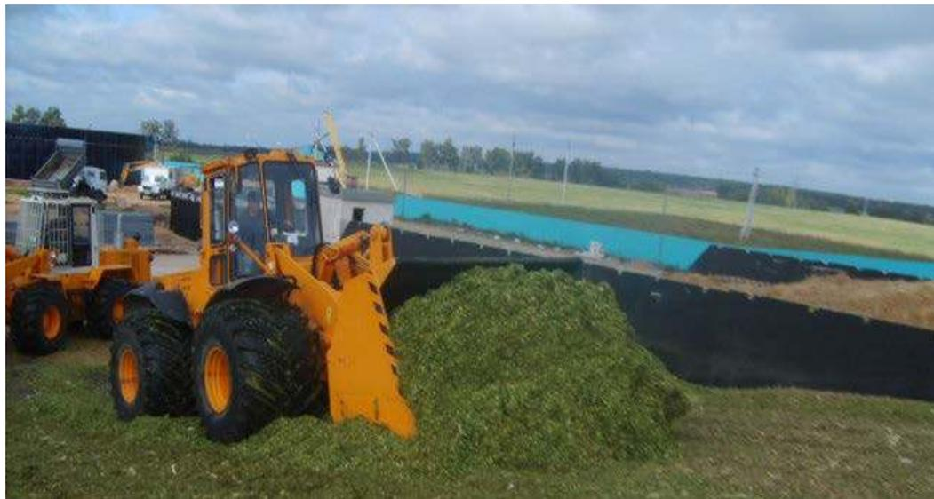
Предназначен для разравнивания и трамбовки силосной и сенажной массы в траншеях.
