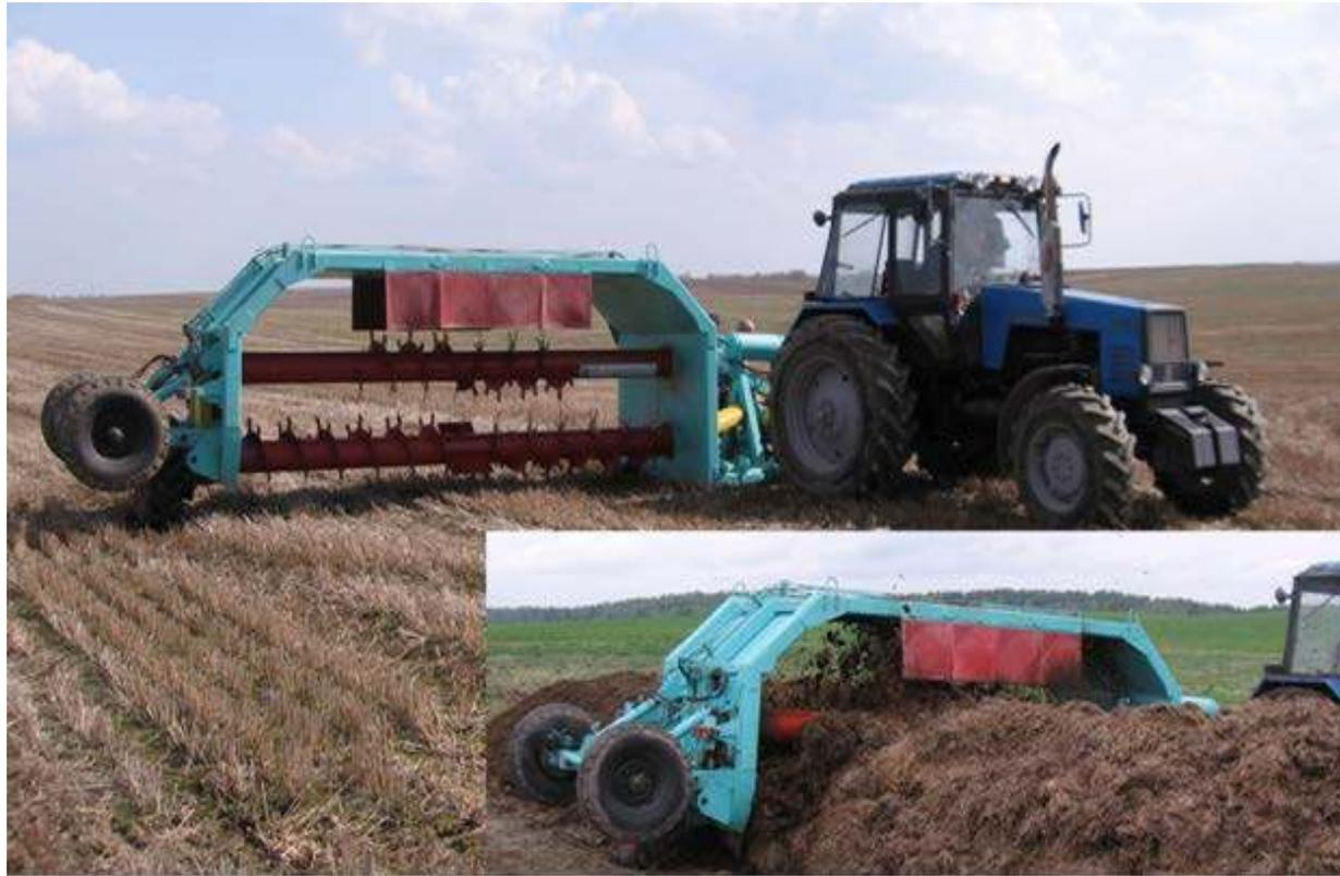
Предназначен для осуществления активной аэрации (перебивки) компостной массы (торфо-соломо-навозной смеси) путем частичного измельчения, перемешивания компонентов и формирования буртов заданной формы.
