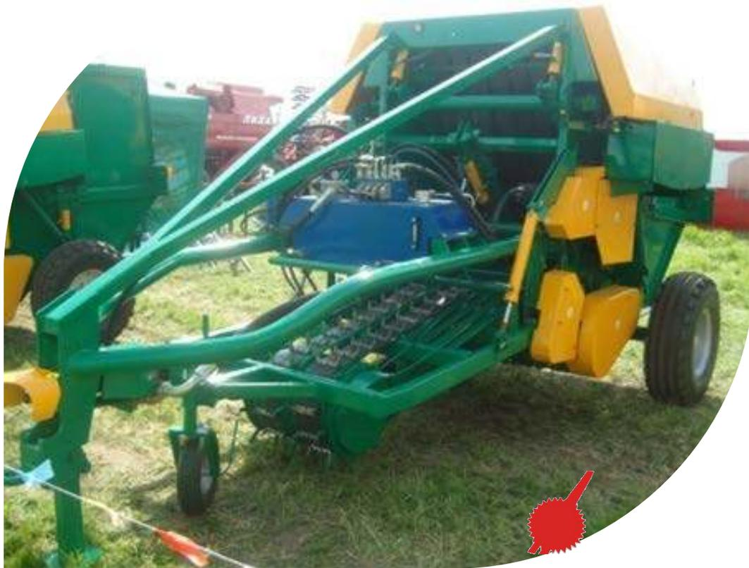
Предназначен для подъема различных типов льнотресты с прессованием в рулоны цилиндрической формы с прокладкой двух нитей шпагата в рулоне и последующей внешней обвязкой..
