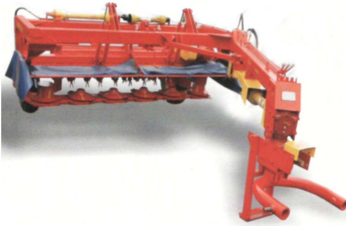
Предназначена для скашивания естественных и сеяных трав на больших площадях с укладкой скошенной травы в валок или прокос.
