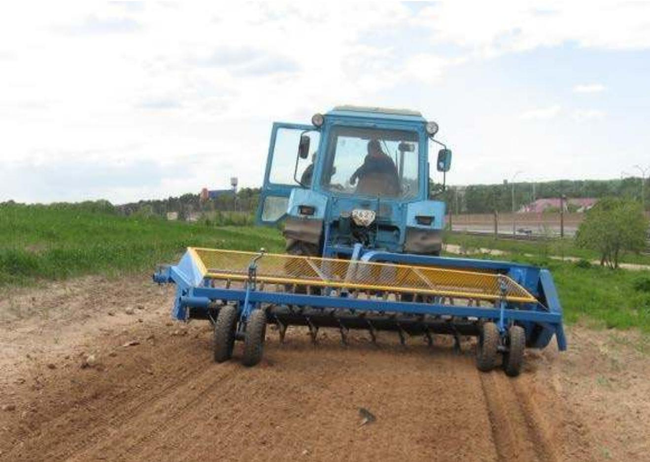
Машина предназначена для сбора в валок поверхностных и погруженных до 0,05 м в почву мелких камней размером от 5 до 30 см на старопахотных минеральных почвах, свободных от сельскохозяйственных культур в весенний, летний и осенний периоды.
