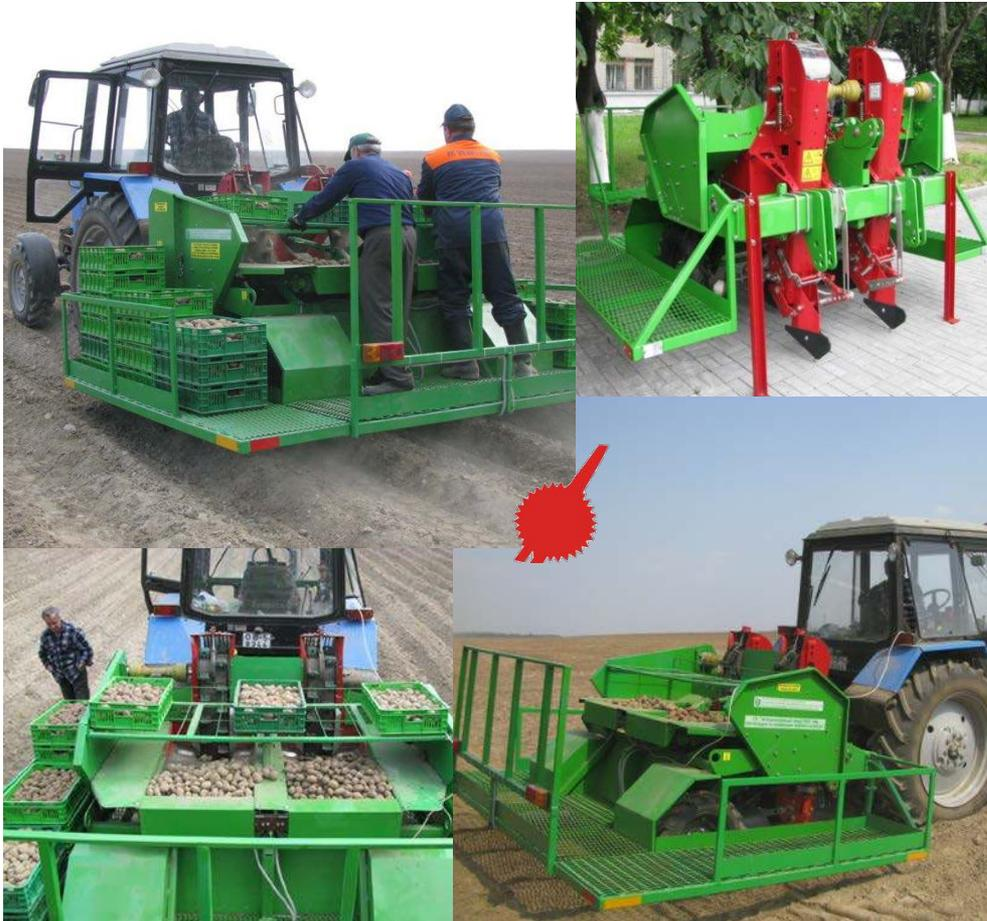
Отличительной особенностью машины является возможность работы на междурядьях – 70 и 75 см. Сажалка КСП-2 имеет систему автоматического отключения подающих транспортеров, обеспечивающих равномерное дозированное заполнение питателей высаживающих аппаратов, что позволяет высаживать пророщенный картофель без повреждения ростков.
