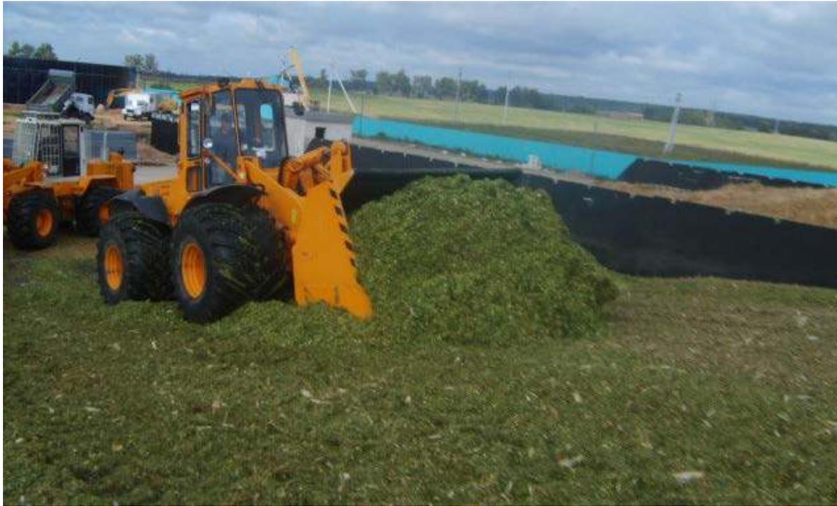
Предназначен для загрузки, равномерного распределения и уплотнения силосуемой массы с одновременным внесением консервантов и обогатительных добавок, а также выгрузки кормов из хранилищ.
