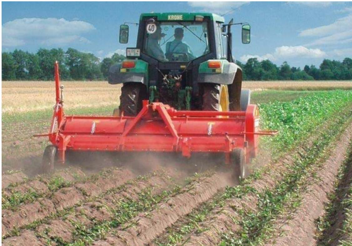
Предназначены для уборки картофельной ботвы с одновременным измельчением.
