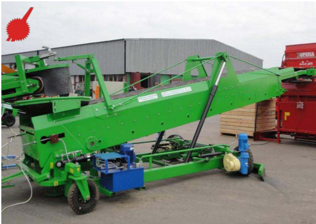
Предназначен для загрузки в хранилища лука и корнеклубнеплодов, а также для загрузки продукции в транспортные средства или в контейнеры. Компоновка загрузчика и его составных частей обеспечивает рациональное использование производственной площади и удобство работы погрузочных и транспортных средств при загрузке продукции и распределении ее в нужном направлении.
