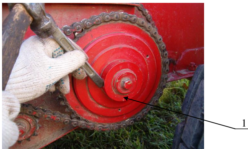
1- гайка регулировочная Рисунок 7 – Регулировка предохранительной муфты подборщика
